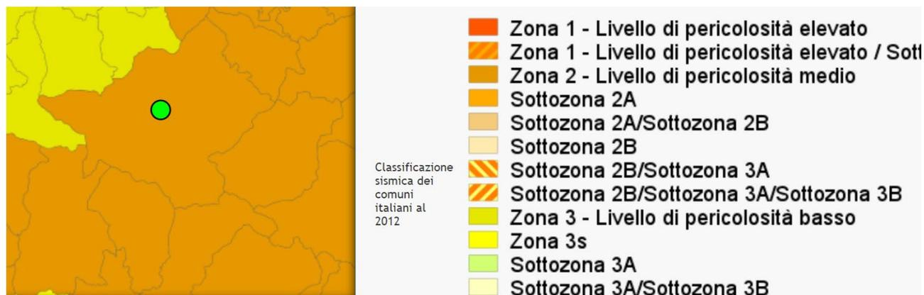
Classificazione sismica area Aerogeneratori sita nel comune di Firenzuola (FI)
