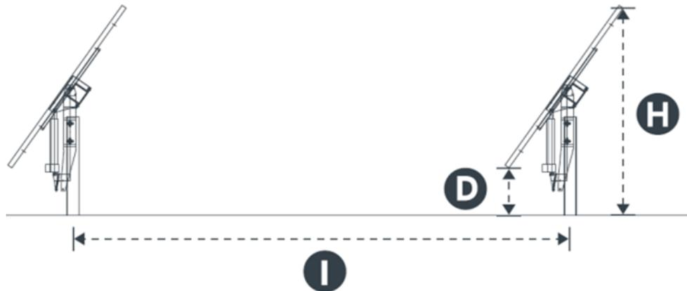
Ciascuna struttura di tracciamento completa, comprese le fondazioni dei pali di spinta, pesa circa 880 kg, una media di 62 tracker (con moduli PV da 450 Wp) sono necessari per ogni 1 MWp.
