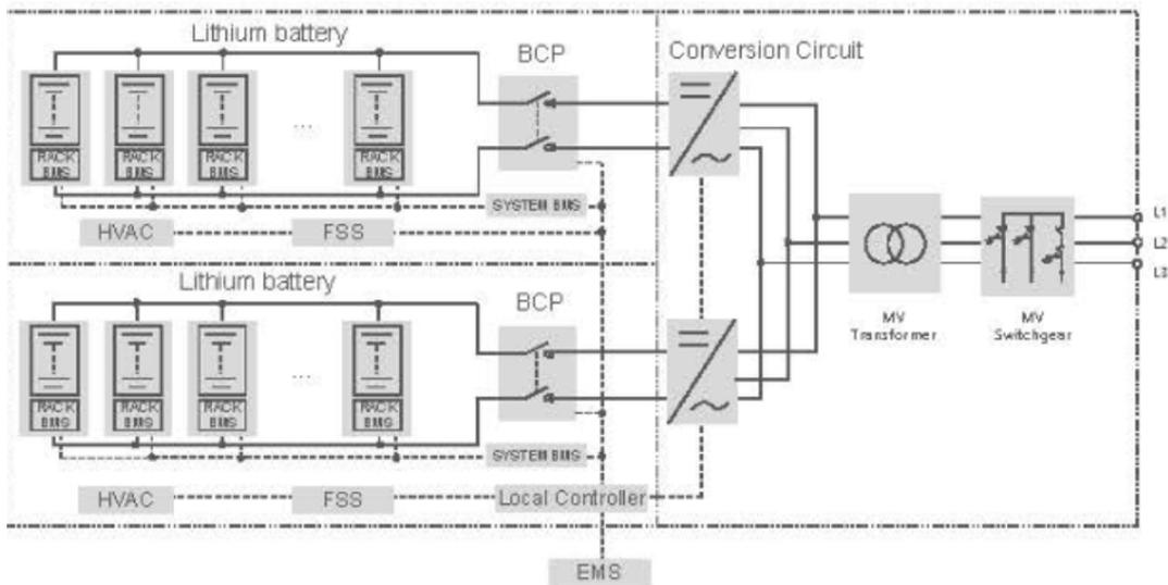
Figura 9 - Schema elettrico sistema di accumulo
