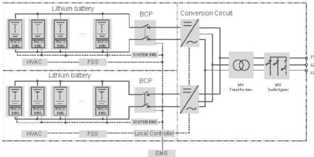
Figura 12 - Schema elettrico sistema di accumulo
