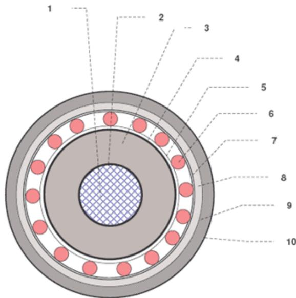
1 CONDUTTORE: corda rigida rotonda, compatta e tamponata di alluminio. Sez. 1.600 mm<sup>2</sup>
