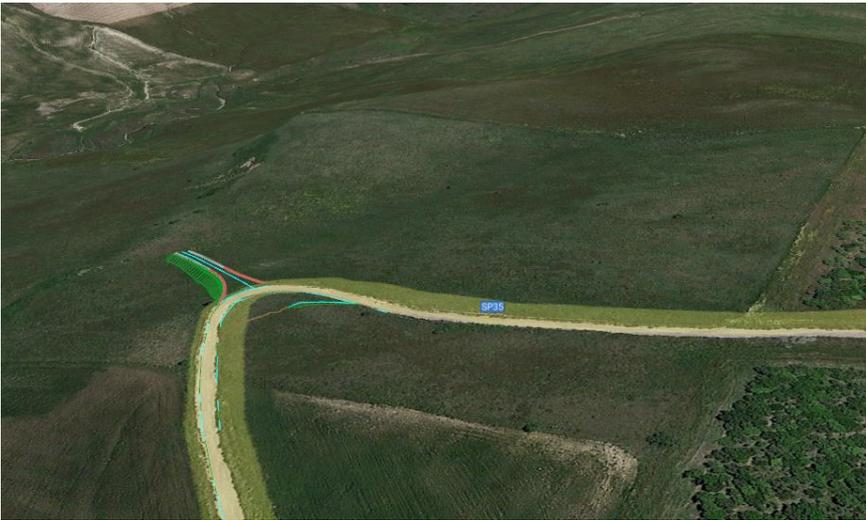
**Asse 04\_AD:** Consiste nell'allargamento della piattaforma stradale esistente, senza modifica sostanziale dell'attuale sedime, che, partendo dalla SP 44 e si dirige verso i cluster costituiti dagli aerogeneratori S06, S08 e S09 e a dagli aerogeneratori S13, S11 e S10.
