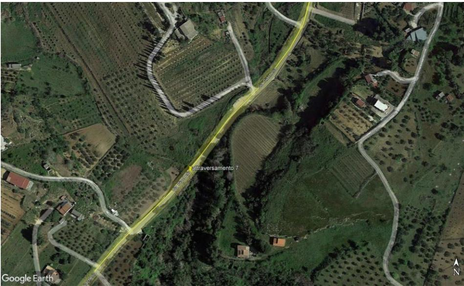
Figura 8-55 - Attraversamento 7 – Interferenza cavidotto con bene tutelato id.082 Vallone Fiume 112 e relativa area buffer: sopra vista dal basso con linea cavidotto in giallo, sotto vista aerea tratta da Google Earth con indicazione attraversamento del corso d'acqua
