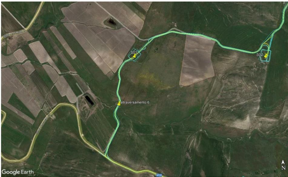
Figura 8-54 - Attraversamento 6 – Interferenza cavidotto con bene tutelato id.082 Vallone Fiume 112 e relativa area buffer: sopra vista dal basso con linea cavidotto in giallo, sotto vista aerea tratta da Google Earth con indicazione attraversamento del corso d'acqua
