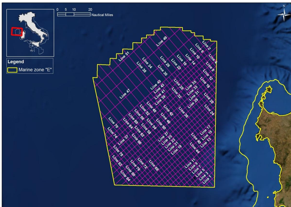
Figura 2.3 – Ubicazione delle linee sismiche, indicate in rosso, all'interno del perimetro dell'istanza del permesso di prospezione.
