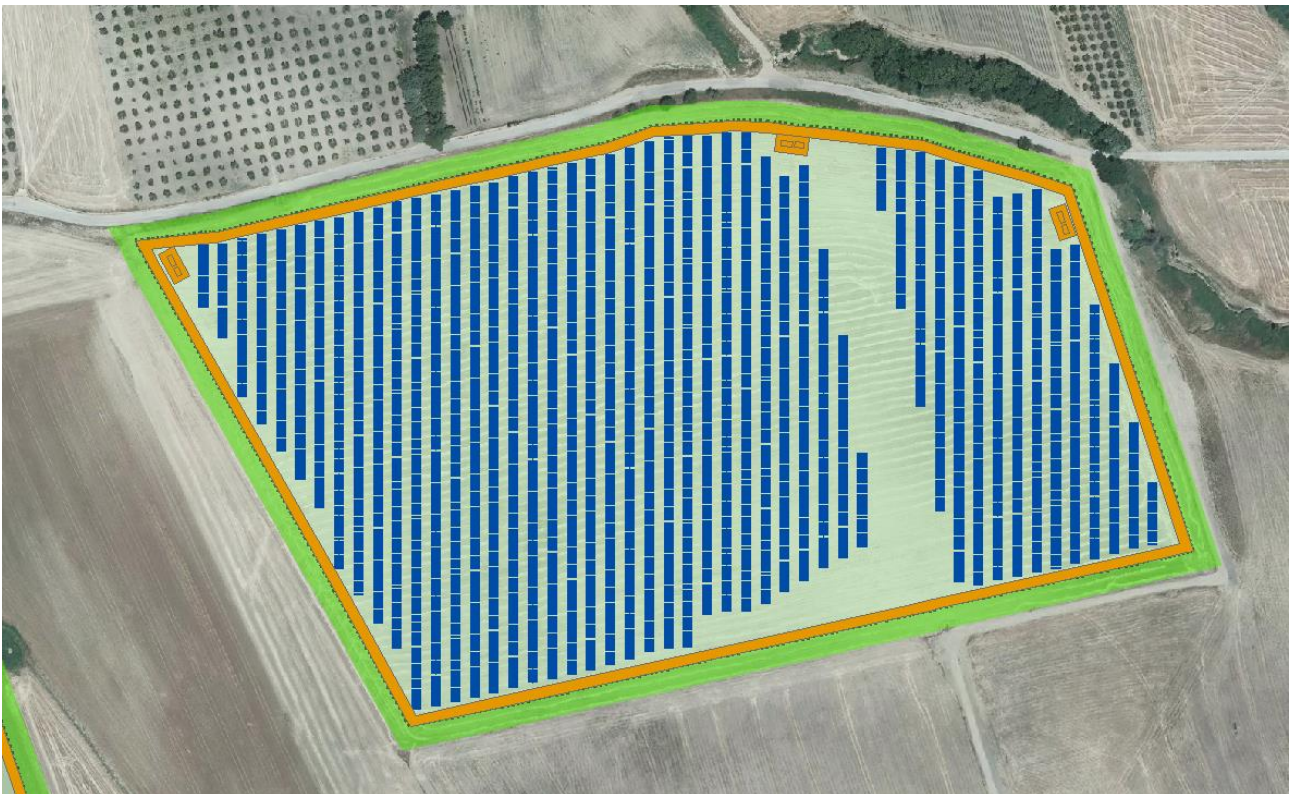
Figura 4.2b. – Layout del sistema agrivoltaico con tracker – dettaglio
