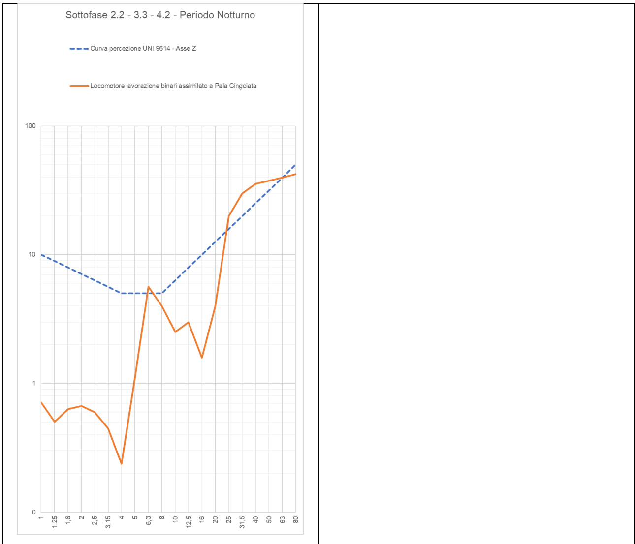
Figura 6-33. Spettri delle sorgenti dei macchinari con confronto con curva di percezione della UNI 9614 per l'asse Z
