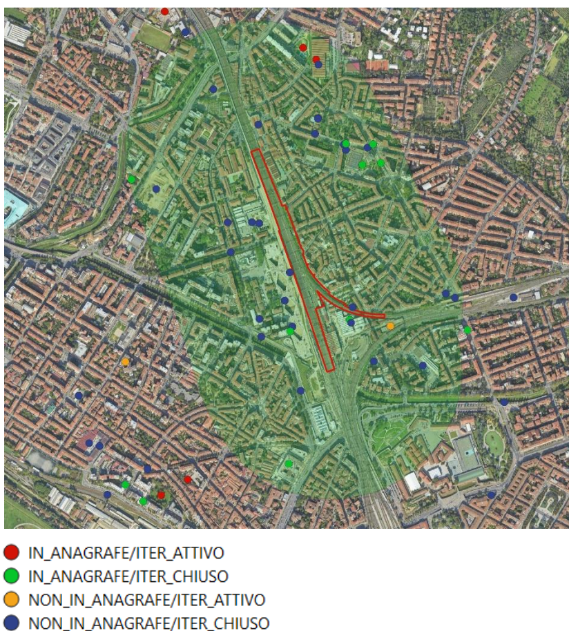
Figura 2-11. Interferenza tra il tracciato e i siti contaminati considerati all’interno di un buffer di 500 metri (Fonte: elaborazione su dati)
