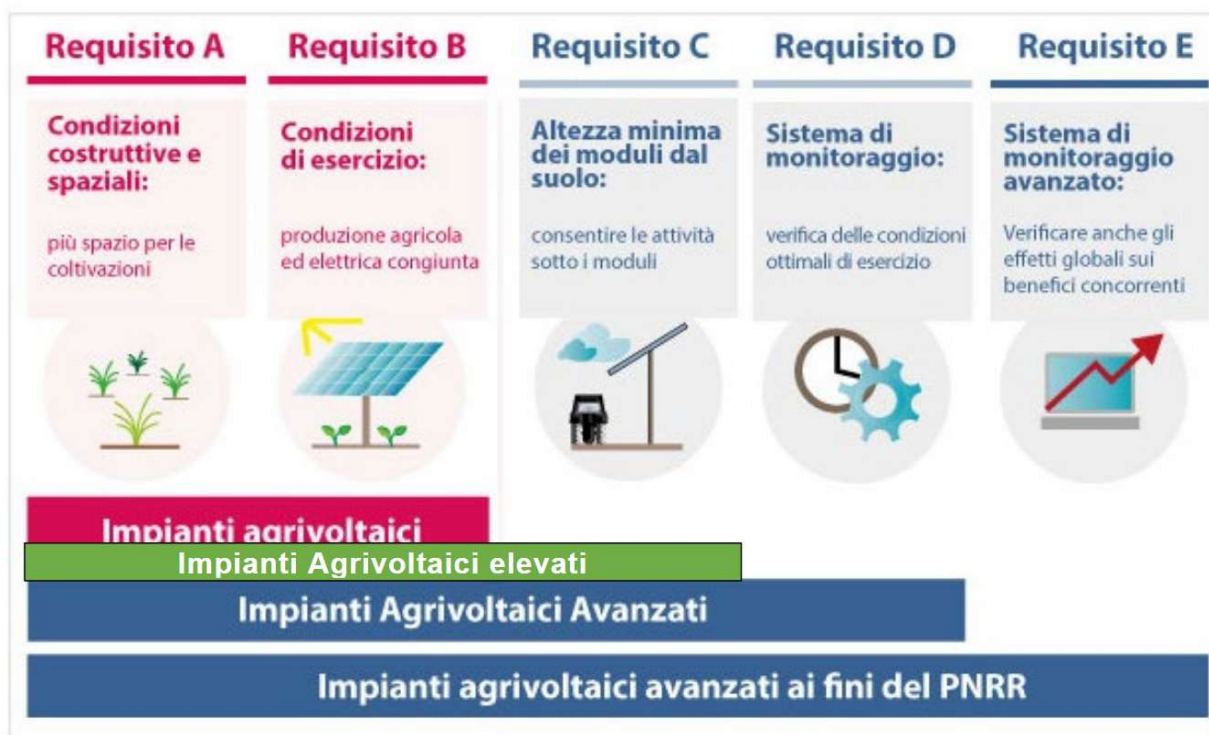
Figura 3-2 – Definizione impianto agrivoltaico in funzione del rispetto dei requisiti
