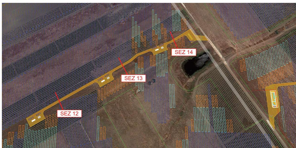
Figura 5-4 – Sezioni per definizione campo magnetico, cavi 36 kV – Area 4
