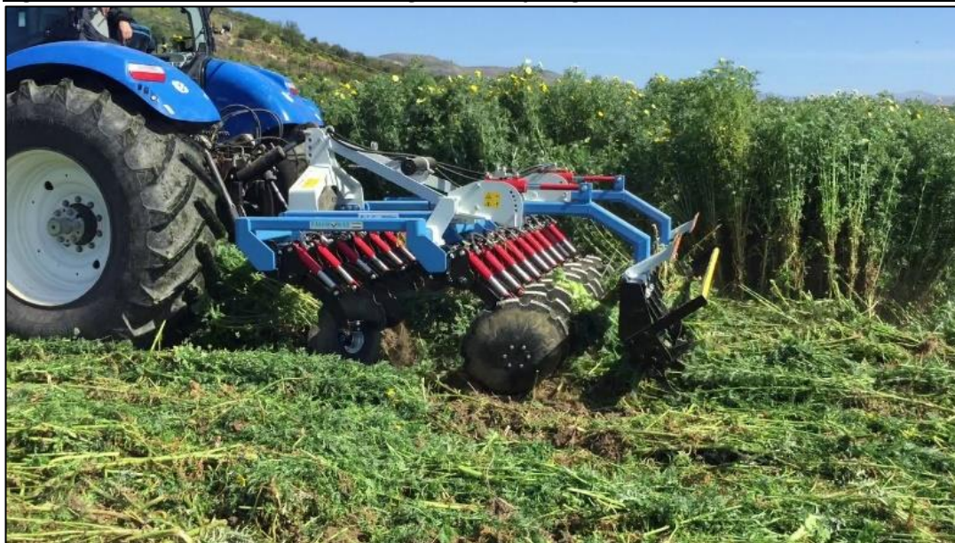
Fig. 8.5: Interramento di materiale vegetale con frangizolle a dischi. (Foto: Siciltiller S.r.l.)
