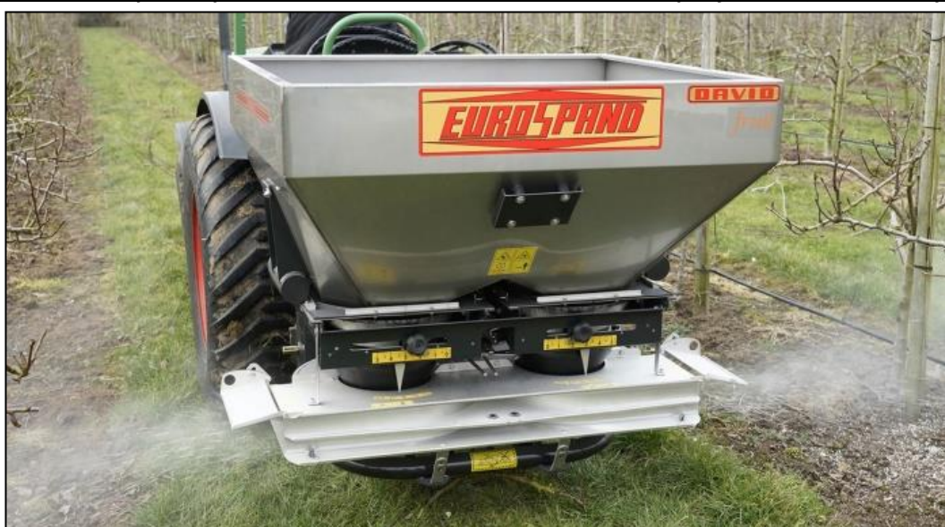
Figura 9.4: esempio di spandiconcime localizzato mono/bilaterale per frutteti (Foto: EuroSpand)
