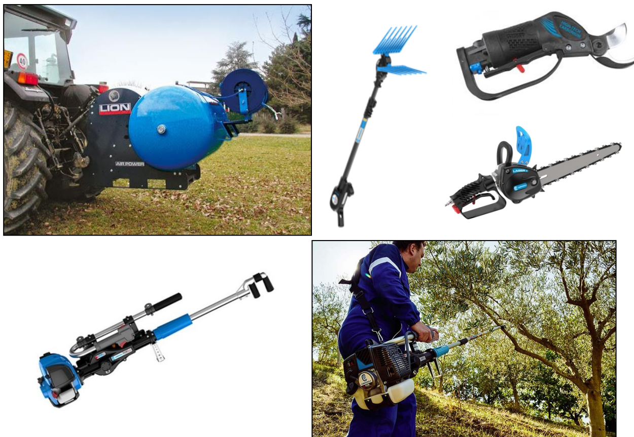
Figura 9.2: Compressore PTO per il funzionamento di strumenti pneumatici per l'arboricoltura e scuotitore motorizzato per la raccolta (Foto: Campagnola)
