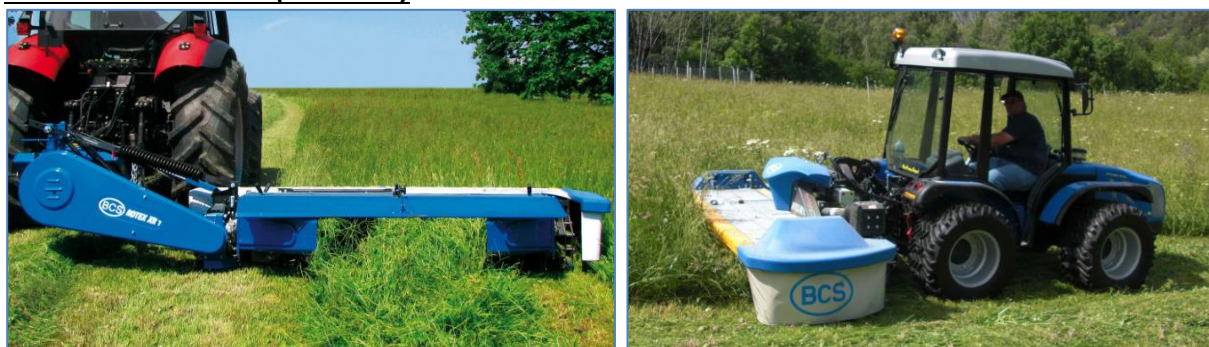
Fig. 8.3: Esempi di falciacondizionatrici fuori asse (a sinistra) e in asse (a destra), quest’ultima più adatta al nostro caso. (Foto: BCS)
