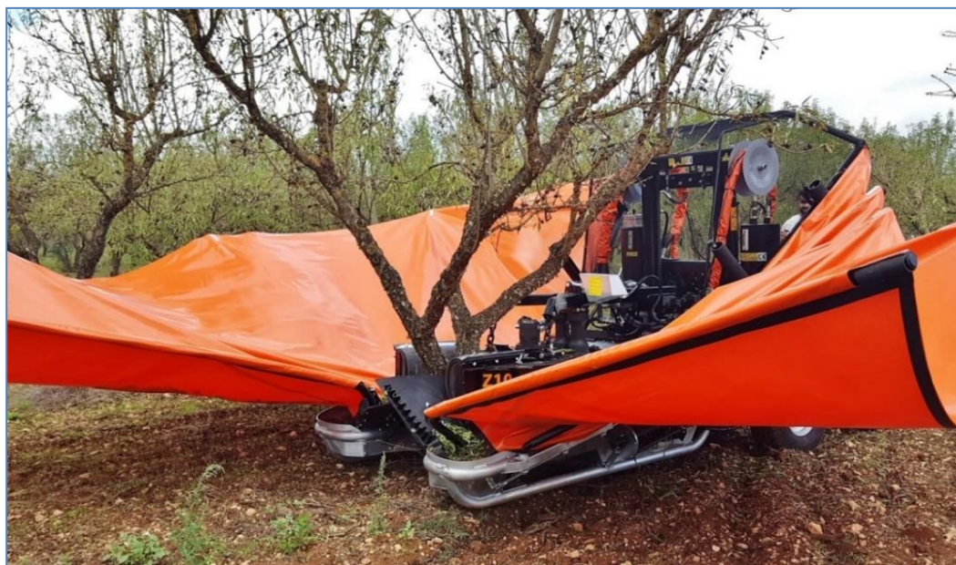
Figura 8.9: Macchina frontale per la raccolta delle olive/mandorle (Foto: Dott. Agr. V. Vitelli)
