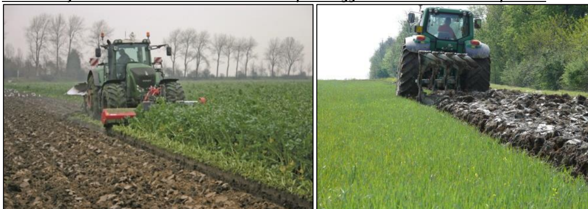
Fig. 8.1: Esempio di pratica del sovescio in pieno campo. Si noti, nell’immagine a sinistra, l’impiego di una trincia frontale montata sulla stessa trattore per alleggerire il carico sull’aratro portato
