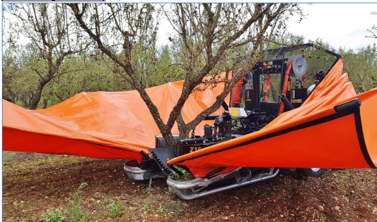
Figura 2.3: Macchina frontale per la raccolta delle olive/mandorle su intensivo (Foto: Dott. Agr. Vito Vitelli)
