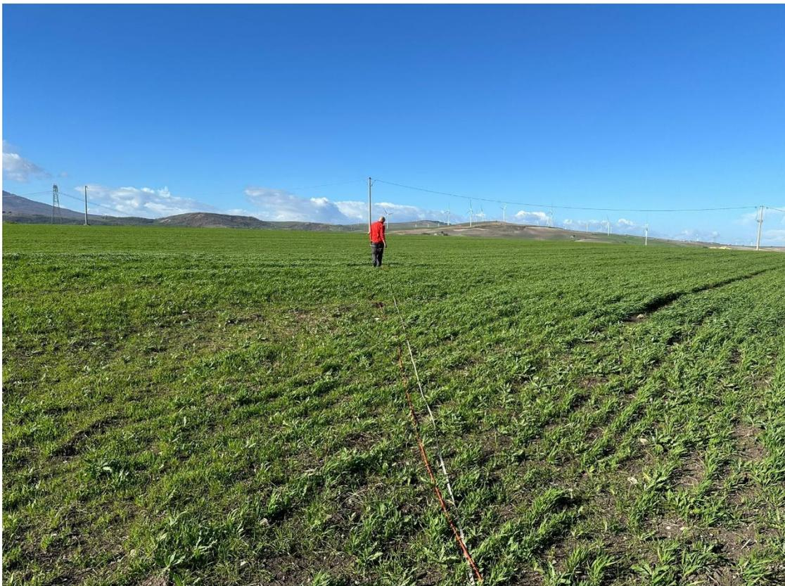
*Esecuzione profilo sismico a rifrazione 2*
