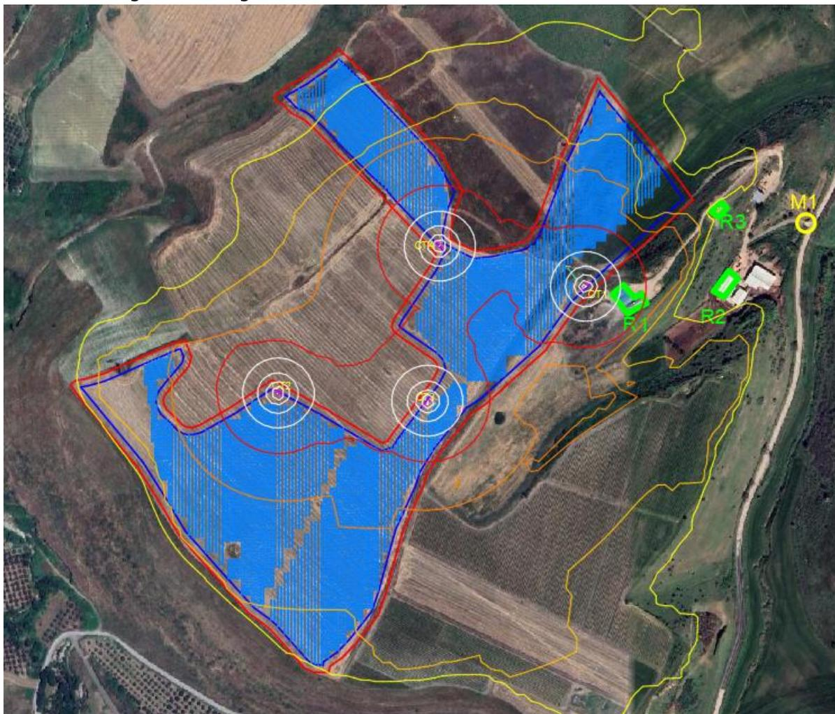
Figura 4 – Risultato della simulazione con linee di iso-rumorosità colorate da 20 dB (Rossa) a 10 (Gialla)
