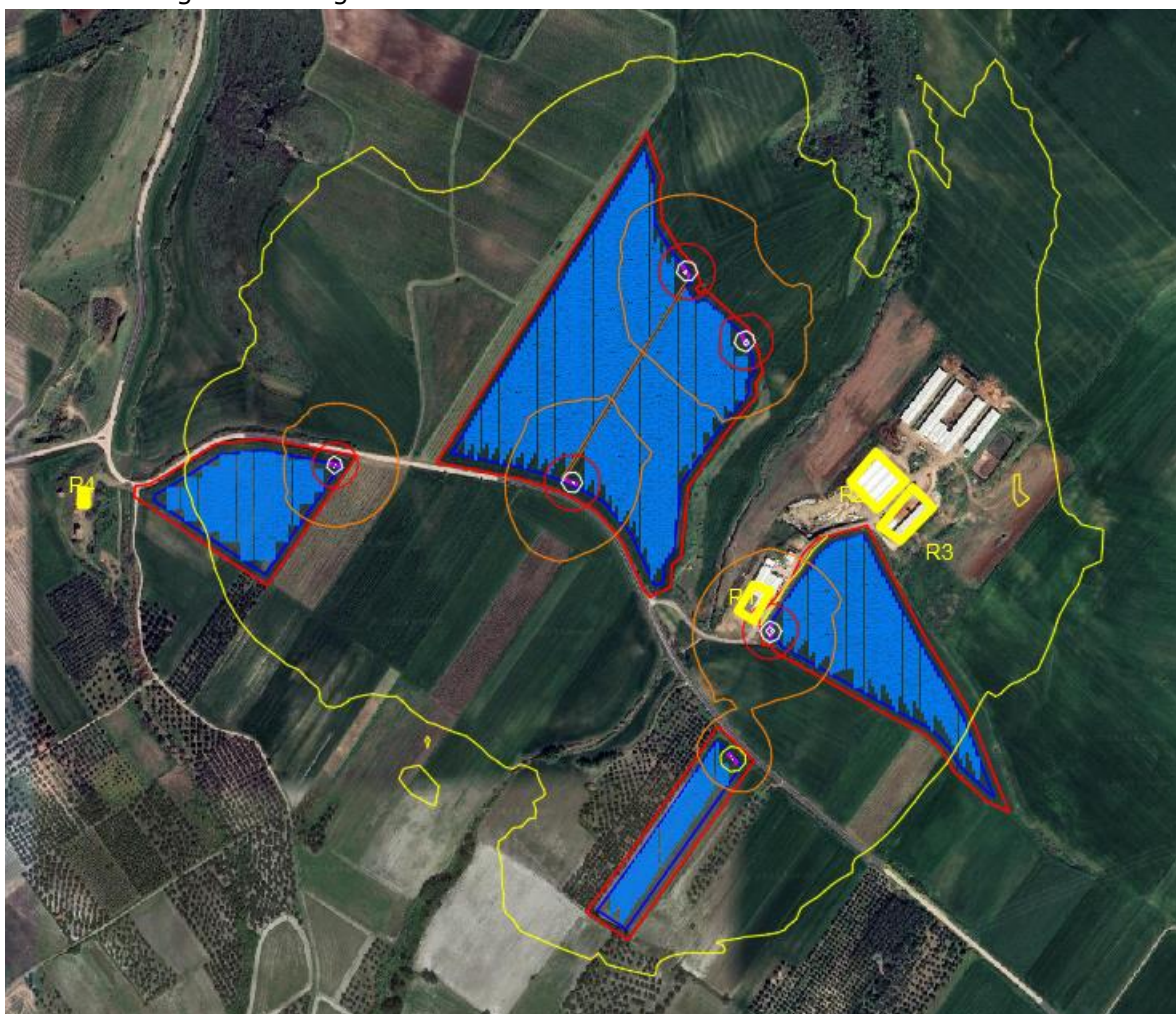
Figura 4 – Risultato della simulazione con linee di iso-rumorosità colorate da 30 dB (Rossa), 20 dB (Arancione) e 10 (Gialla)
