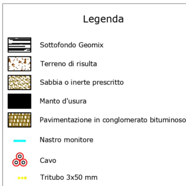
Figura 12 – Materiali di riempimento per scavo cavi esterni
