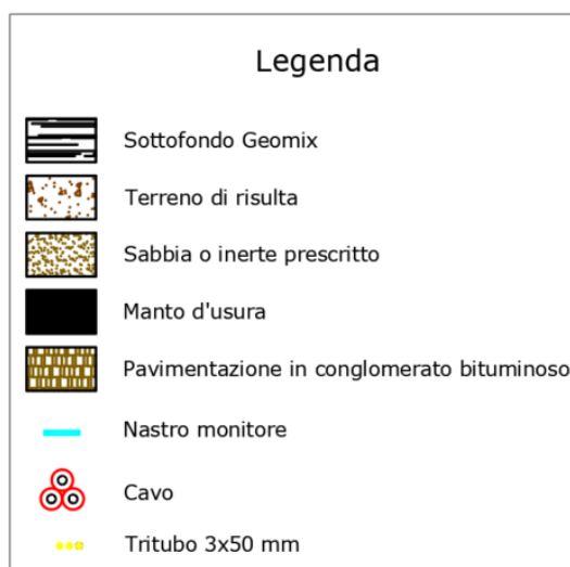
Figura 12 – Materiali di riempimento per scavo cavi esterni
