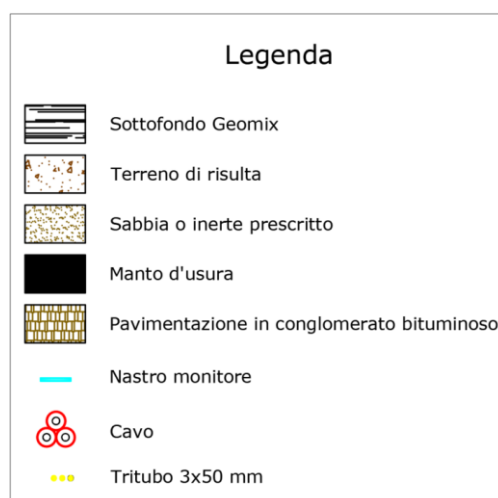
Figura 7 - Materiali di riempimento per tipologia di scavo
