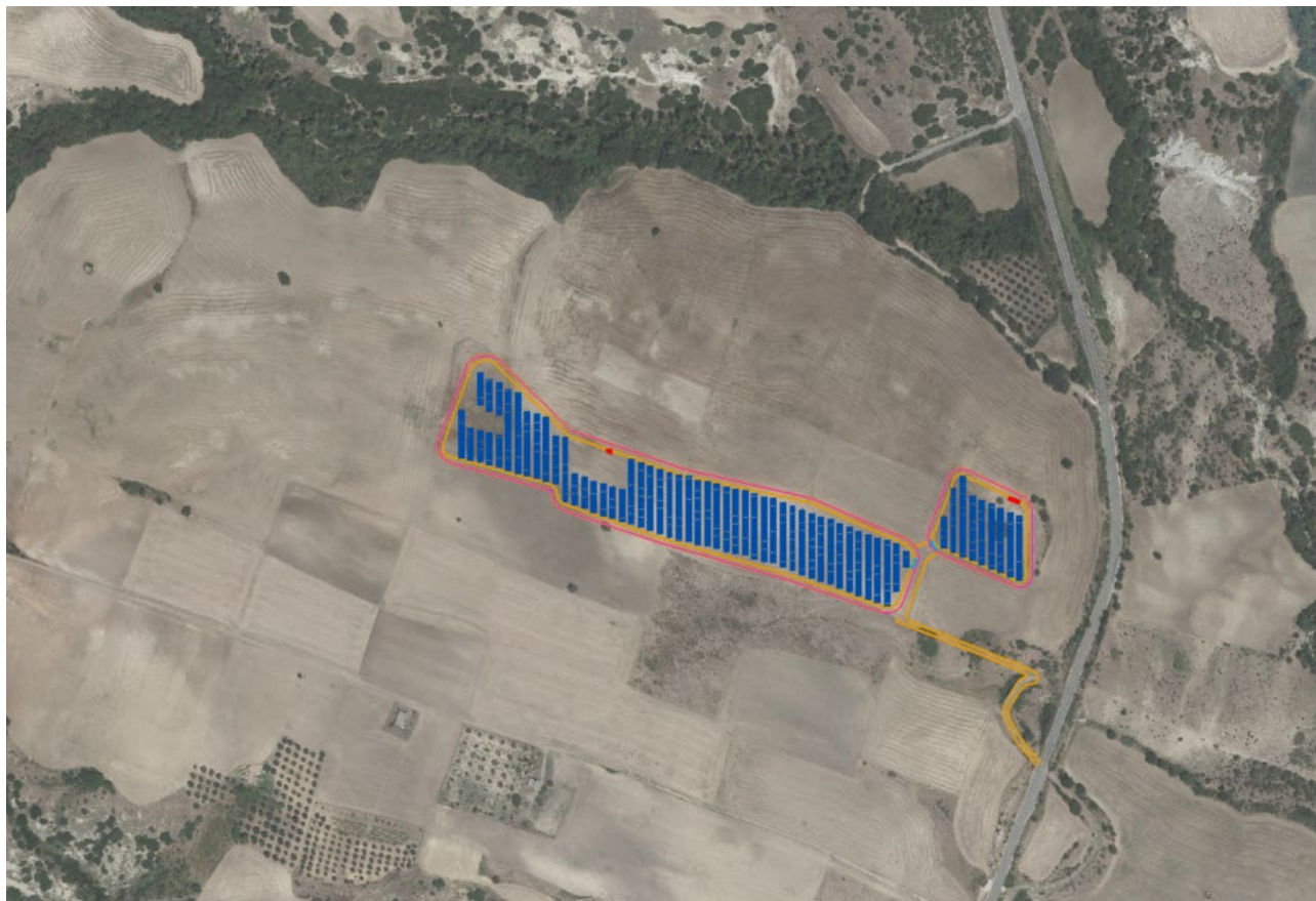
Figura 4.2. – Layout del sistema agrivoltaico con tracker.
