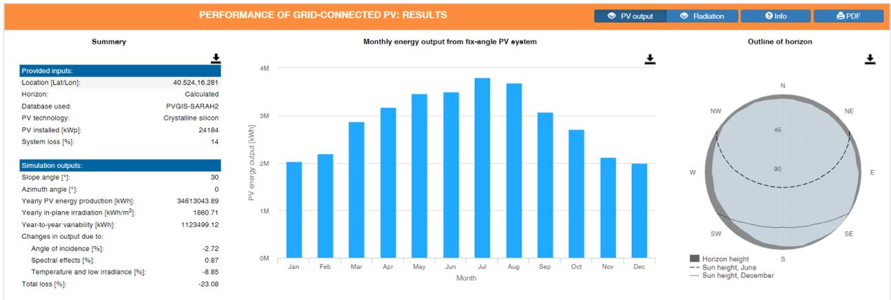
Figura 3.7. – Rendimento dell'impianto e delle caratteristiche tecnico-produttive con supporti fissi.
