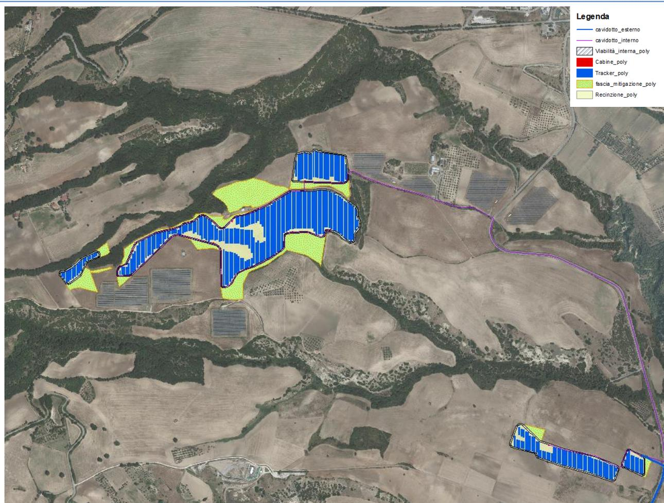
Figura 2.1 – Area di progetto con indicazione degli interventi agronomici e posizionamento dei moduli fotovoltaici.
