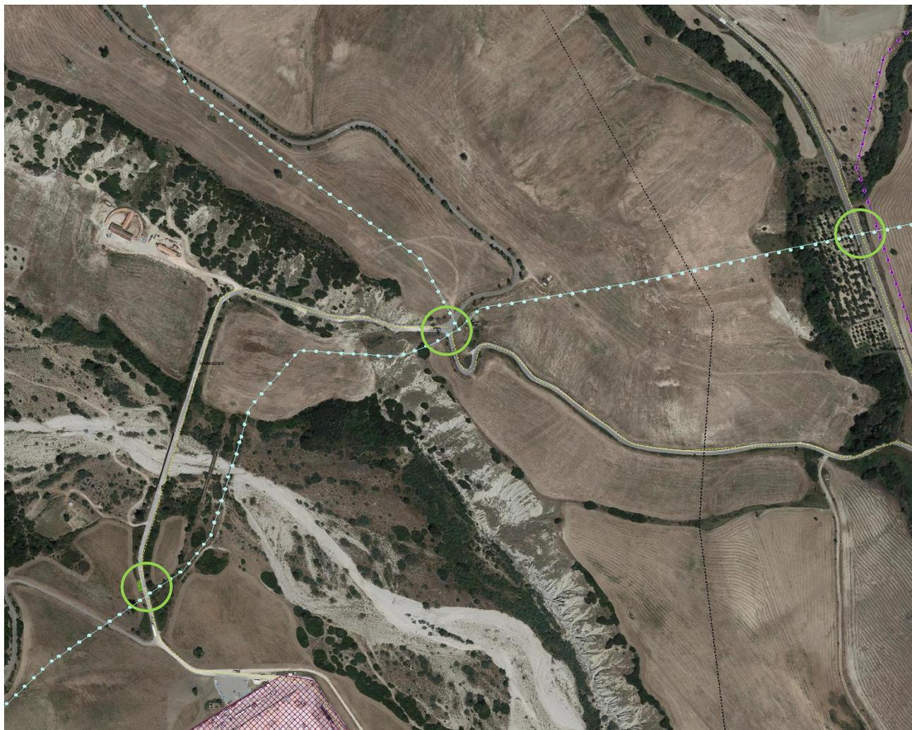
Figura 3.6a. – Dettaglio dell’Interferenza (in verde) del cavidotto esterno con la rete dell’acquedotto.
