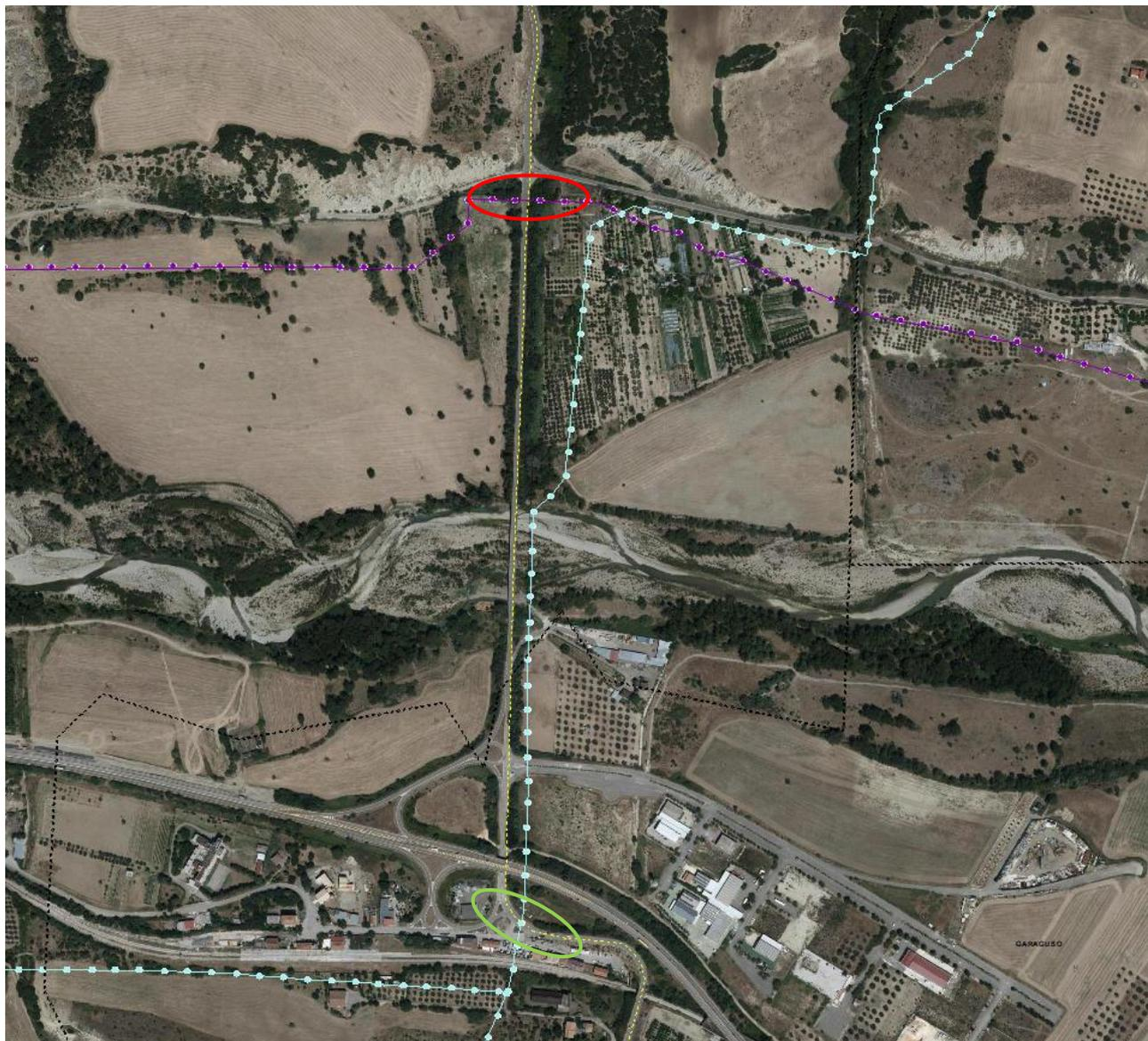
Figura 3.6. – Dettaglio dell'Interferenza del cavidotto esterno con la rete del metanodotto (in rosso) e dell'acquedotto (in verde).
