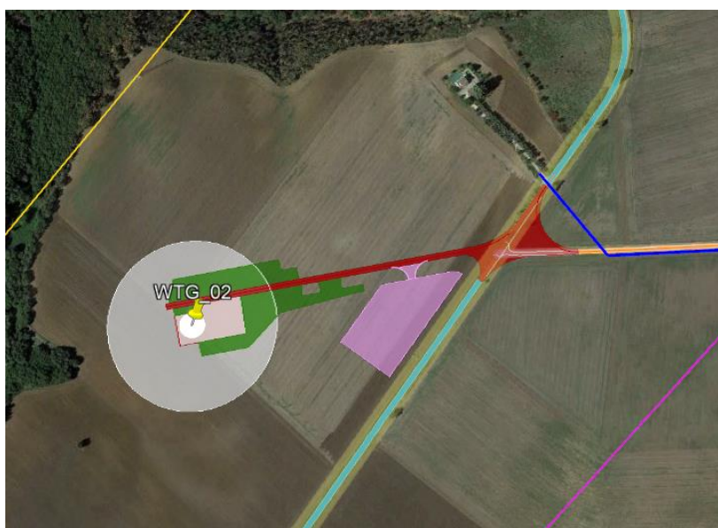
Figura 135: Area di cantiere e stoccaggio nei pressi della torre WTG02
