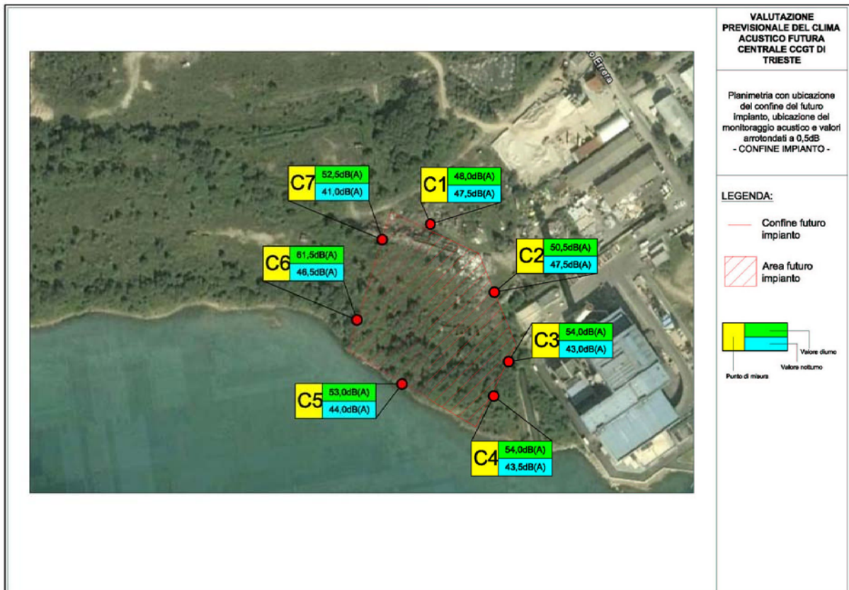
Fig. 1.2 – Monitoraggio acustico ante operam condotto in sette punti al confine di proprietà.
