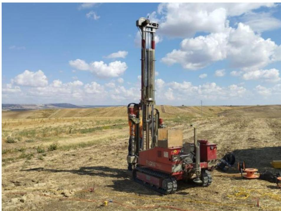
**Figura 31 – Penetrometro dinamico superpesante PAGANI TG63-200 Kn; fase esecuzione sondaggio penetrometrico.**
