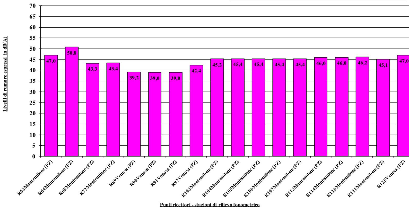
**Figura 27 - Livelli cumulativi di rumorosità Li producibile dall'impianto nell'area di intervento: WS (HH)=9,0 m/s**
