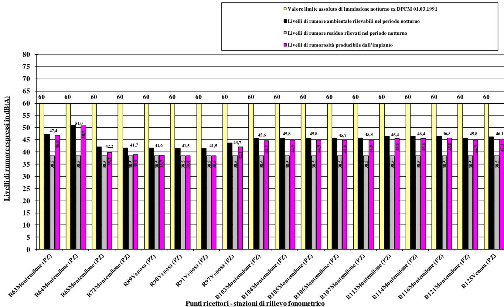
**Figura 23/B Livelli di rumore ambientale  $L_{a,n}$  rilevabili nel tempo di riferimento notturno:  $WS(HH)=6,2$  m/s**
