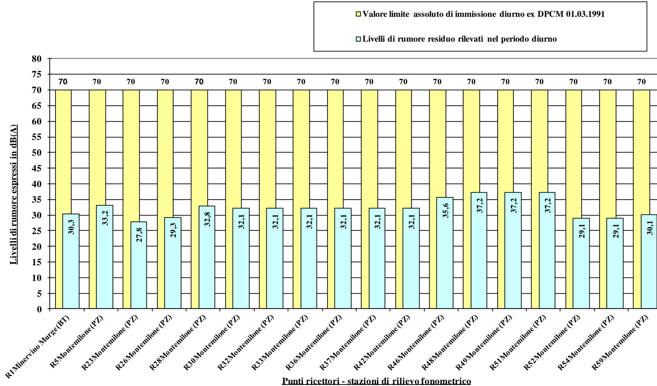
Figura 1/A: Livelli di rumore residuo Lr rilevati nel tempo di riferimento diurno
