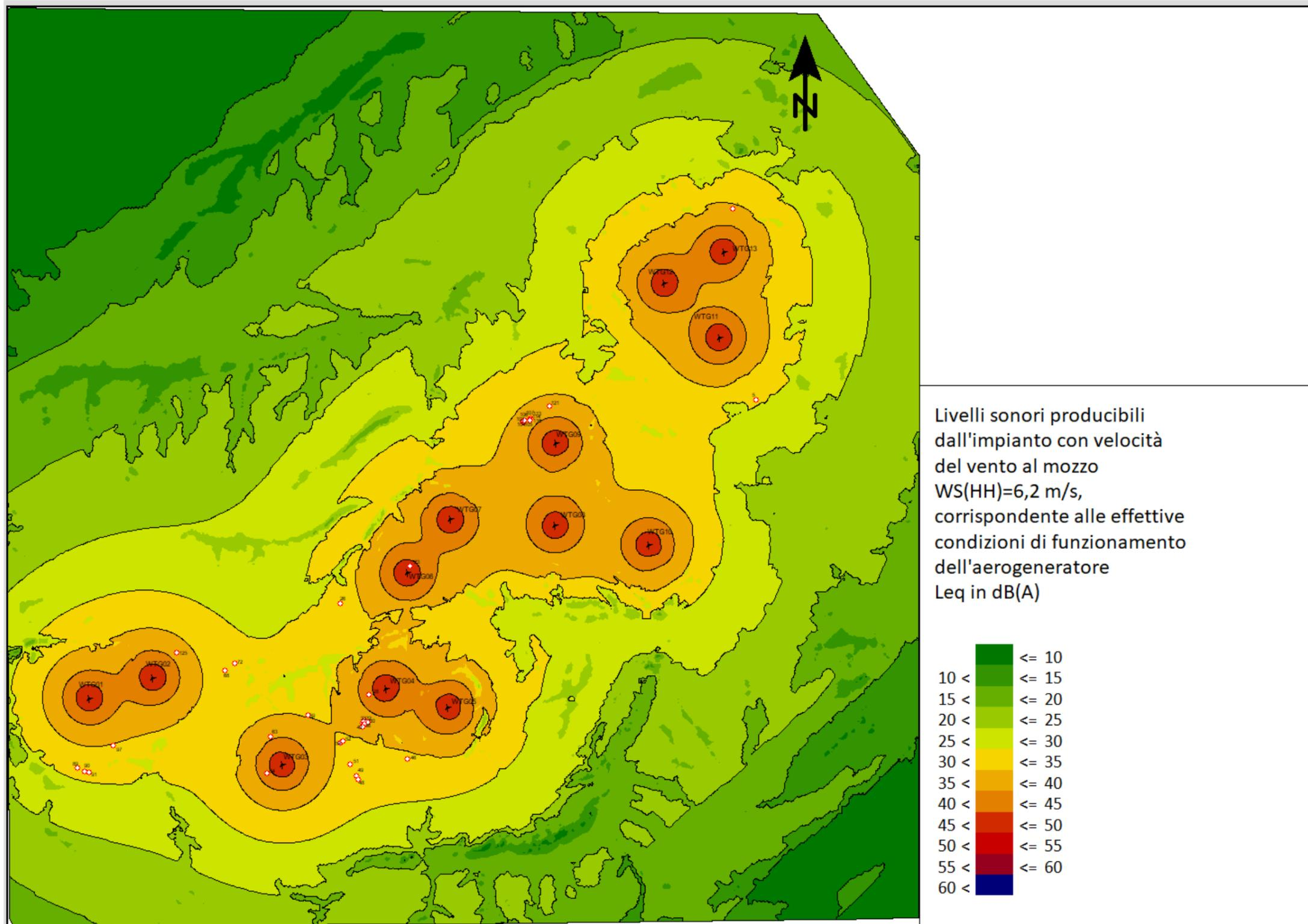
Figura 24 Mappa dei livelli di rumorosità dell'impianto  $WS(HH)=6,2$  m/s
