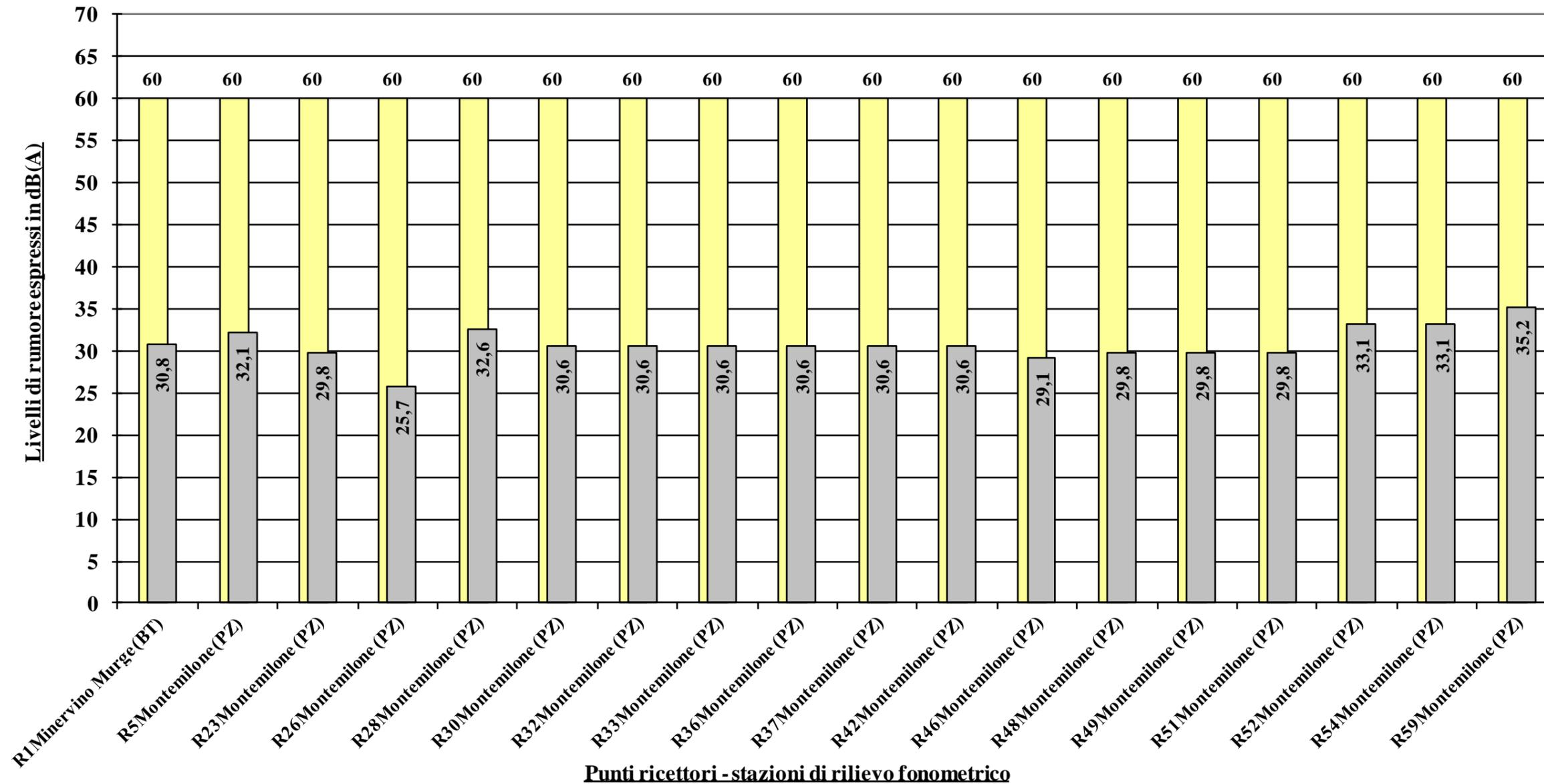
Figura3/A: Livelli di rumore residuo Lr rilevati nel tempo di riferimento notturno
