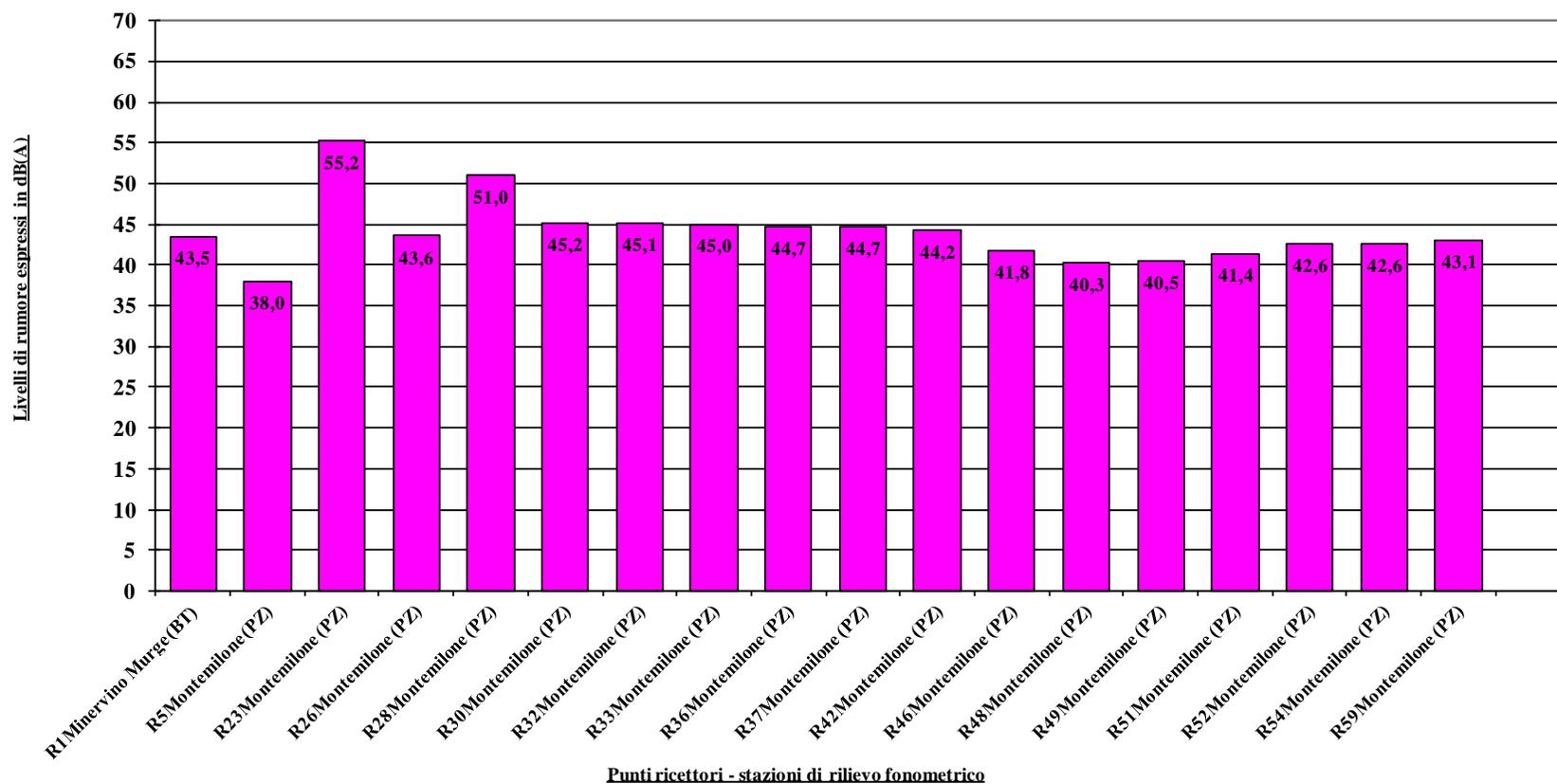
**Figura 29/A - Livelli cumulativi di rumorosità Li producibile dall'impianto nell'area di intervento: WS (HH)=9,0 m/s**
