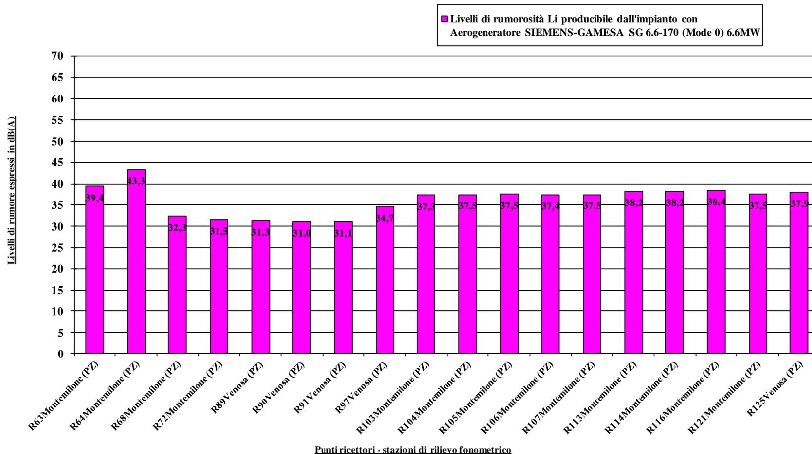
**Figura 21/B Livelli di rumorosità Li producibile dall'impianto nell'area di intervento: WS (HH)=6,2 m/s**
