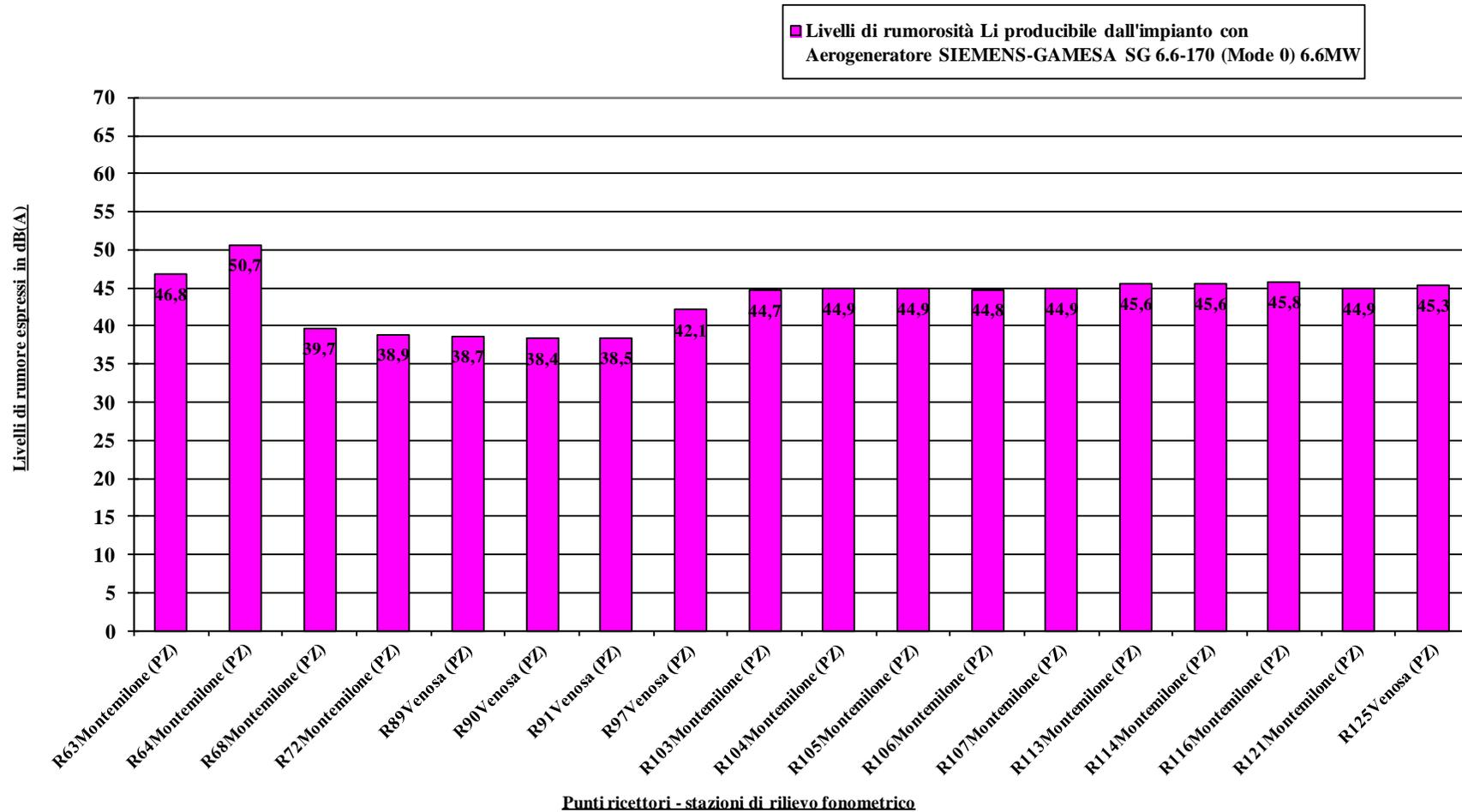
**Figura 11/B Livelli di rumorosità Li producibile dall'impianto nell'area d'intervento: WS (HH)=9,0 m/s**
