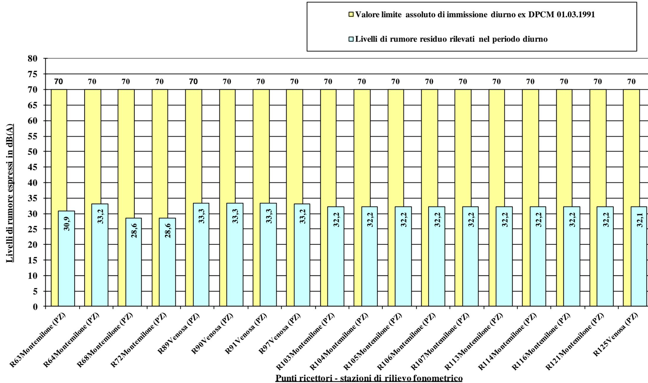
Figura 2/B: Livelli di rumore residuo Lr rilevati nel tempo di riferimento diurno
