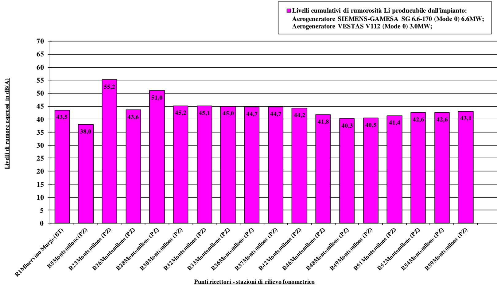
**Figura 26/A - Livelli cumulativi di rumorosità Li producibile dall'impianto nell'area di intervento: WS (HH)=9,0 m/s**
