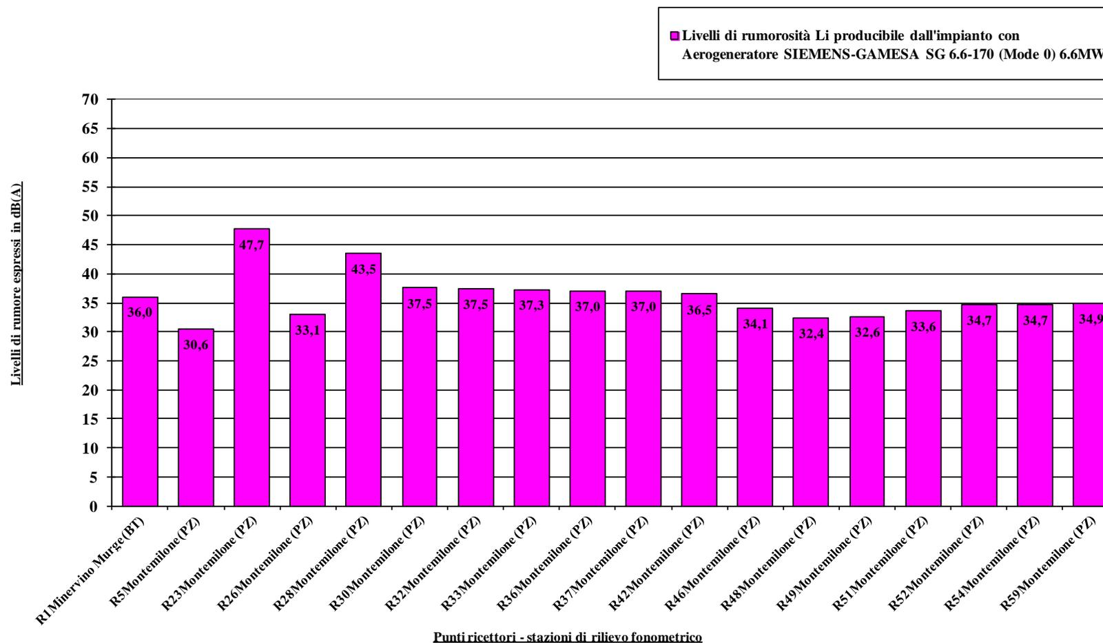
**Figura 20/A Livelli di rumorosità Li producibile dall'impianto nell'area di intervento: WS (HH)=6,2 m/s**
