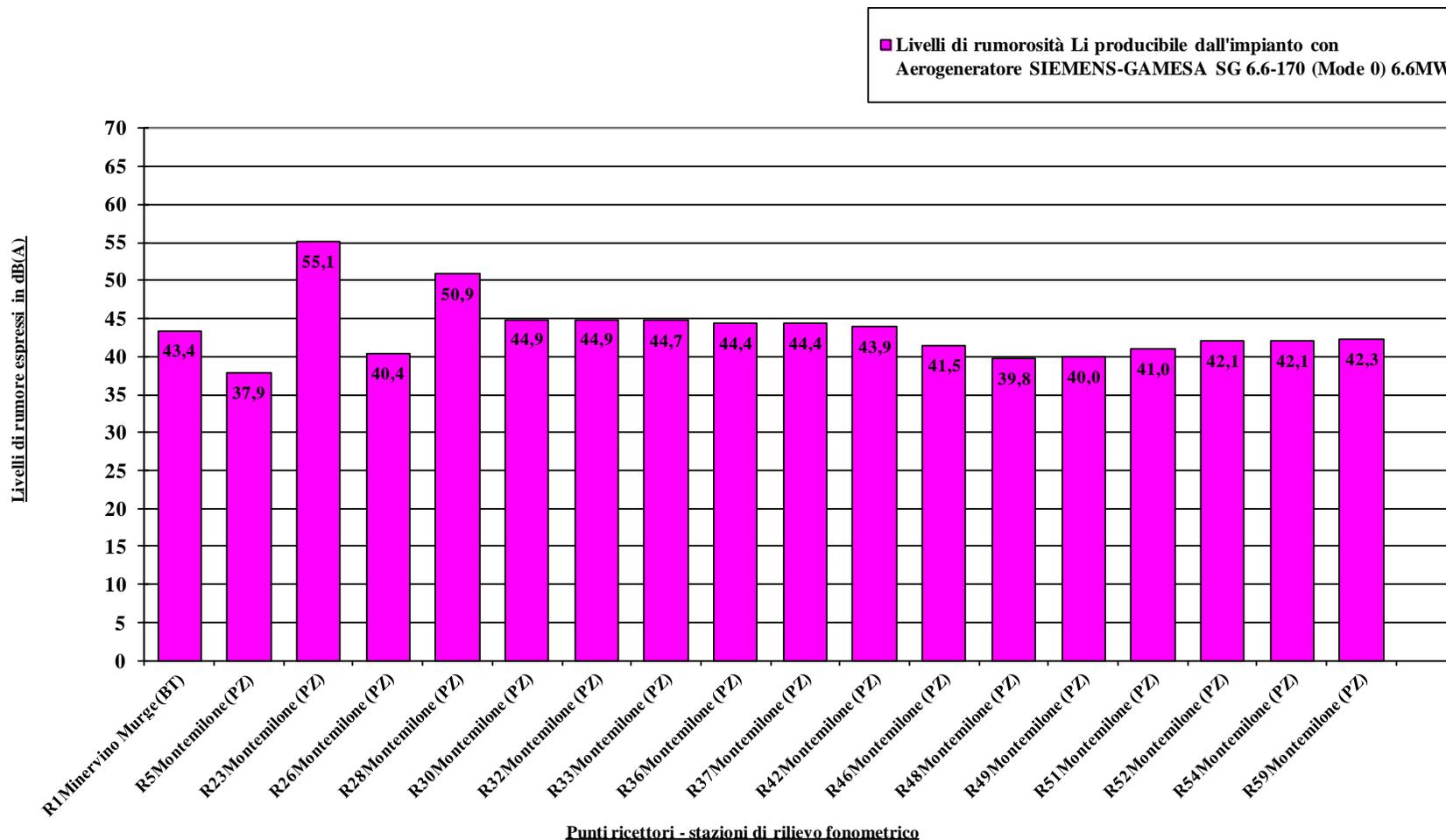
**Figura 10/A Livelli di rumorosità Li producibile dall'impianto nell'area d'intervento: WS (HH)=9,0 m/s**
