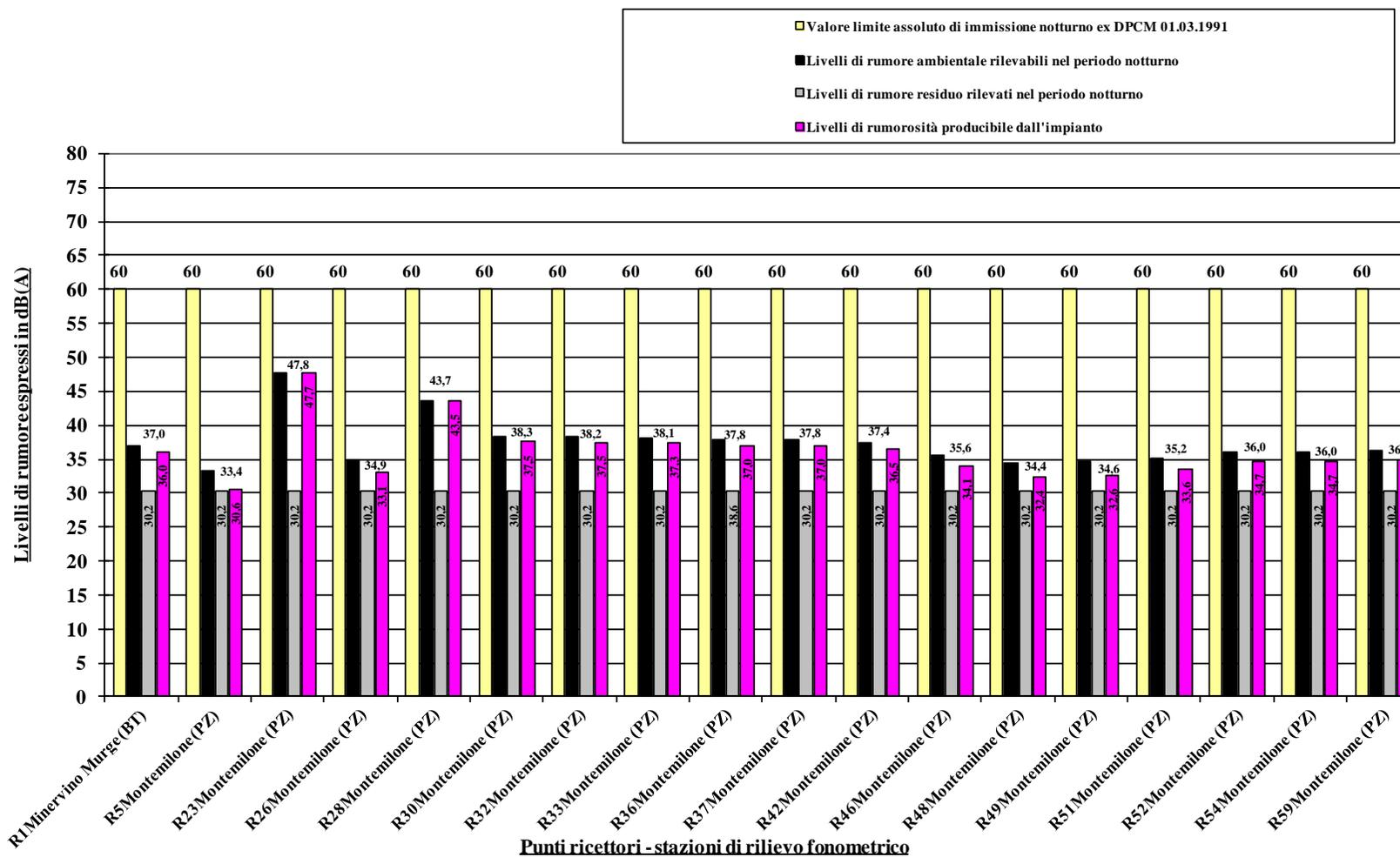
**Figura 22/A Livelli di rumore ambientale  $L_{a,n}$  rilevabili nel tempo di riferimento notturno:  $WS(HH)=6,2$  m/s**
