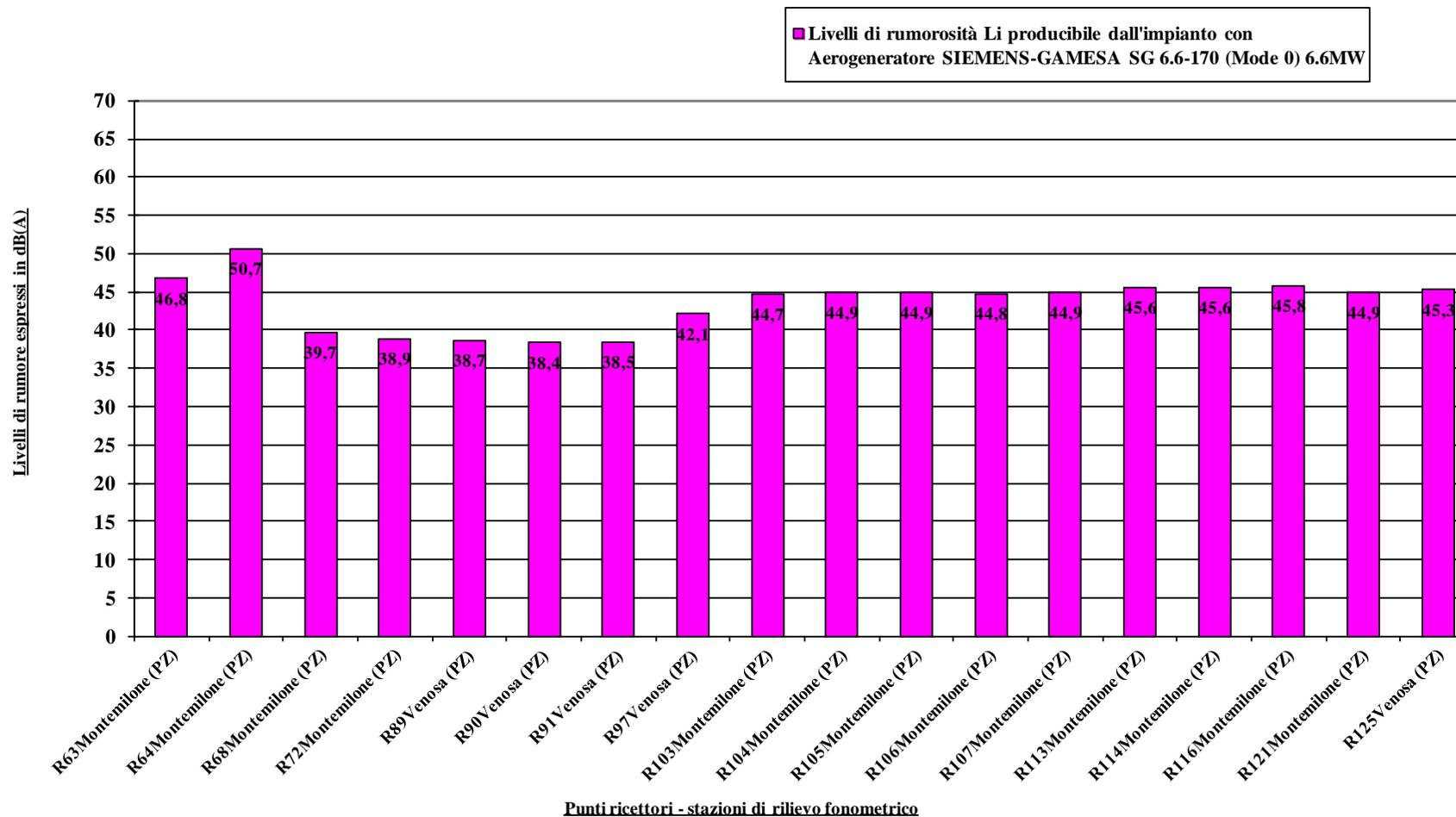
**Figura 7/B Livelli di rumorosità Li producibile dall'impianto nell'area d'intervento: WS (HH)=9,0 m/s**
