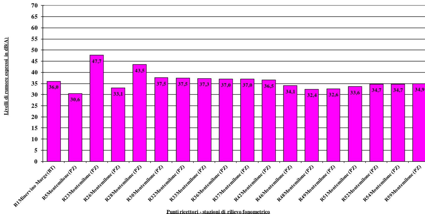
**Figura 16/A Livelli di rumorosità Li producibile dall'impianto nell'area di intervento: WS (HH)=6,2 m/s**
