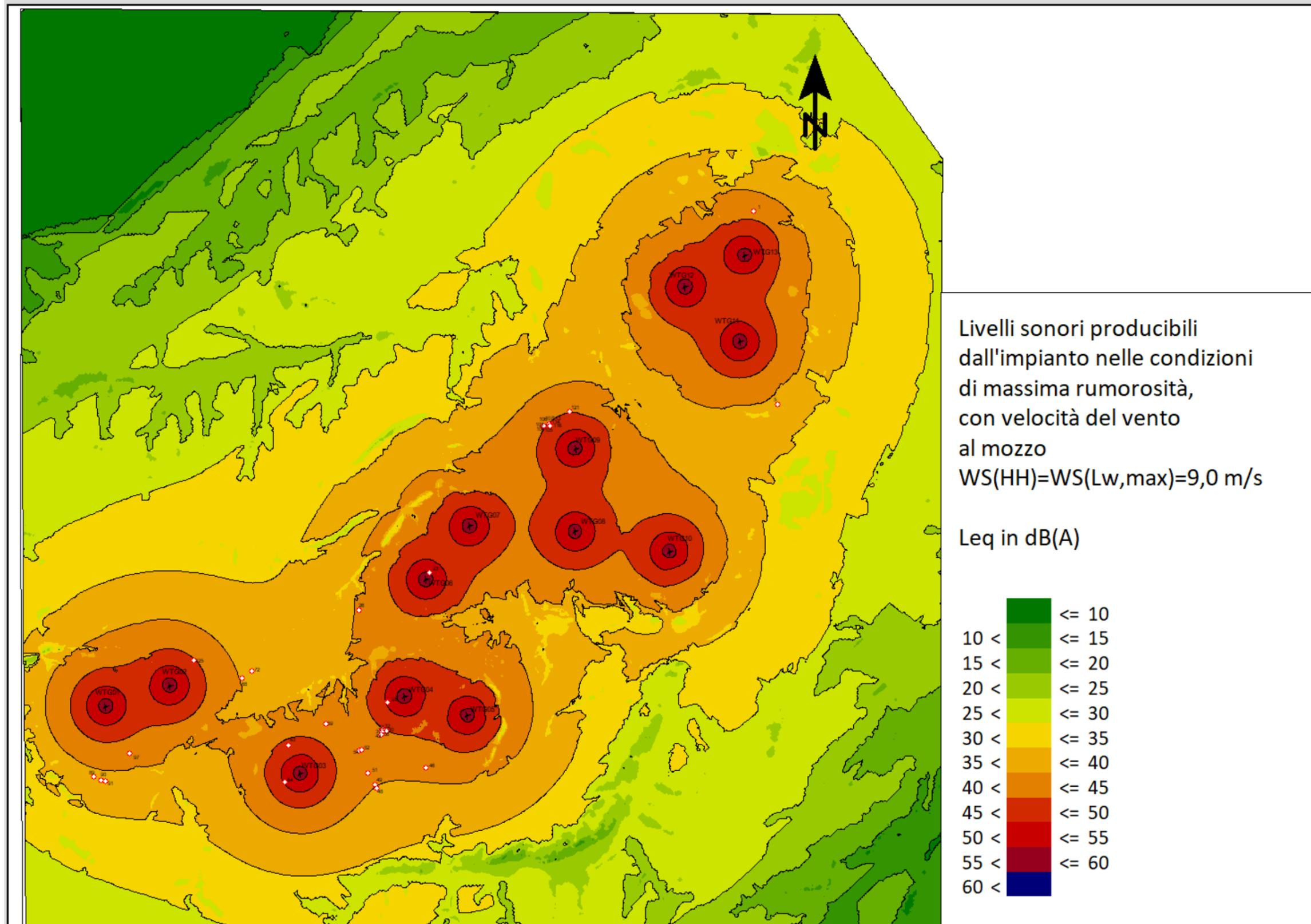
Figura 14 Mappa dei livelli di rumorosità dell'impianto  $WS(HH)=9,0$  m/s
