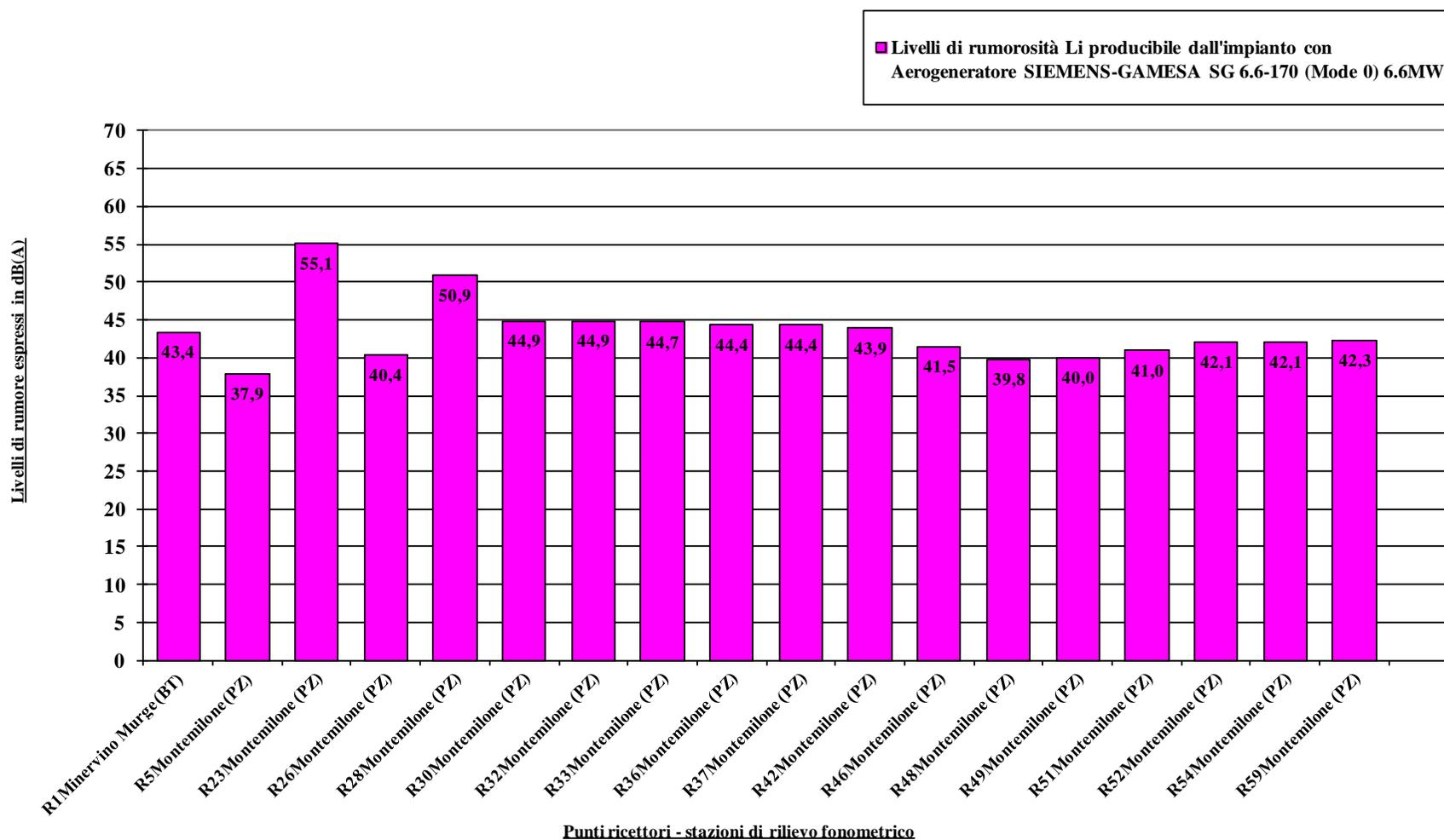
**Figura 6/A Livelli di rumorosità Li producibile dall'impianto nell'area d'intervento: WS (HH)=9,0 m/s**
