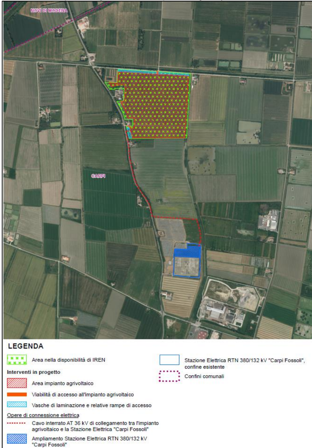
Figura 2 – Inquadramento su ortofoto dell'impianto fotovoltaico
