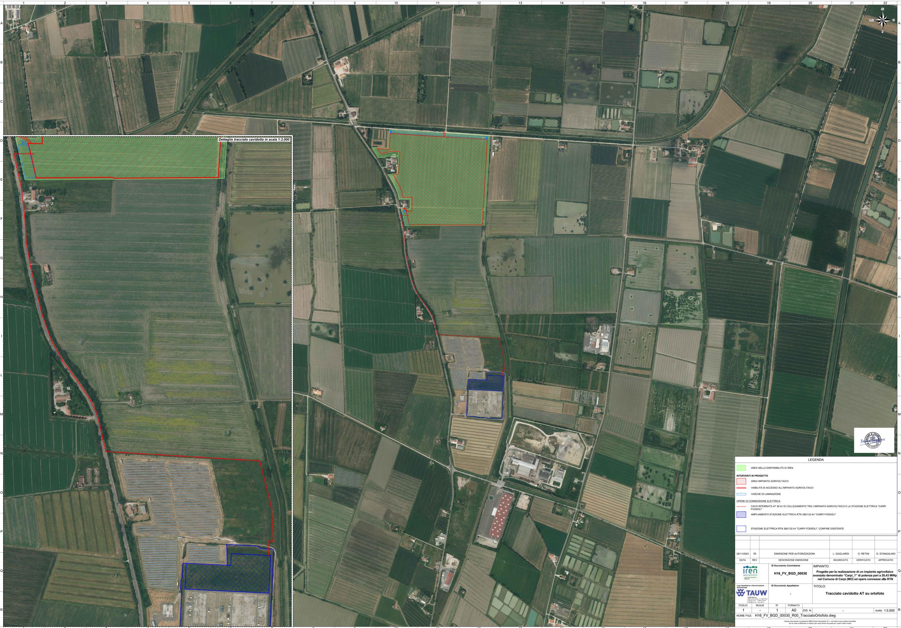
Dettaglio tracciato cavidotto in scala 1:2.000
