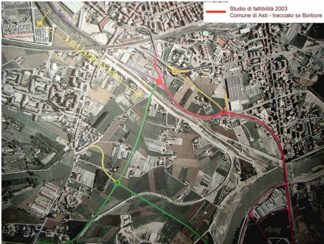
Fig. 2.2.C il Tracciato ipotizzato nello Studio di Fattibilità 2003 Comune di Asti – collegamento in sx Borbore - tratto dal ponte di C.so Savona al sottopasso nella zona critica costituita dall'attraversamento della ferrovia e delle aree commerciale e industriale poste in sx Borbore.
