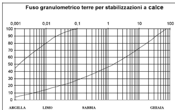
**Figura 1 - Fuso granulometrico di riferimento (CNR-UNI 10006:2002).**
