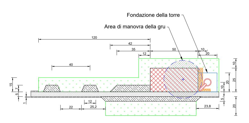
Particolare valido per gli aerogeneratori: WTG01 - WTG02 - WTG03 - WTG05 -WTG06 - WTG09 - WTG11 - WTG12 - WTG14 - WTG16 - WTG17
