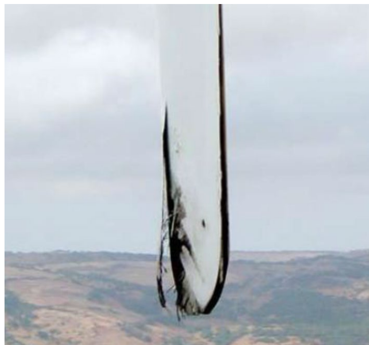
Figura 2 - Estremità della pala danneggiata da fulminazione atmosferica
