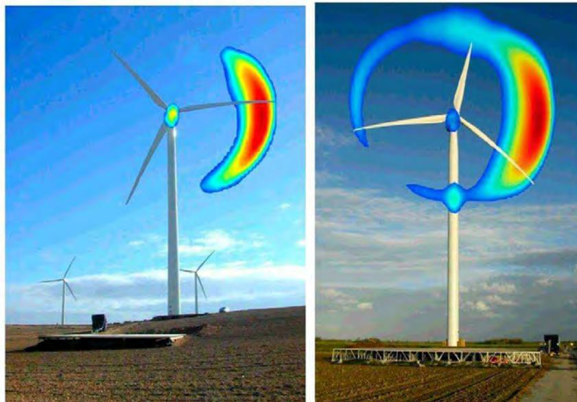
Figura 16: Misura emissione sonora dovuta ai flussi aerodinamici con sistema "beamforming"
