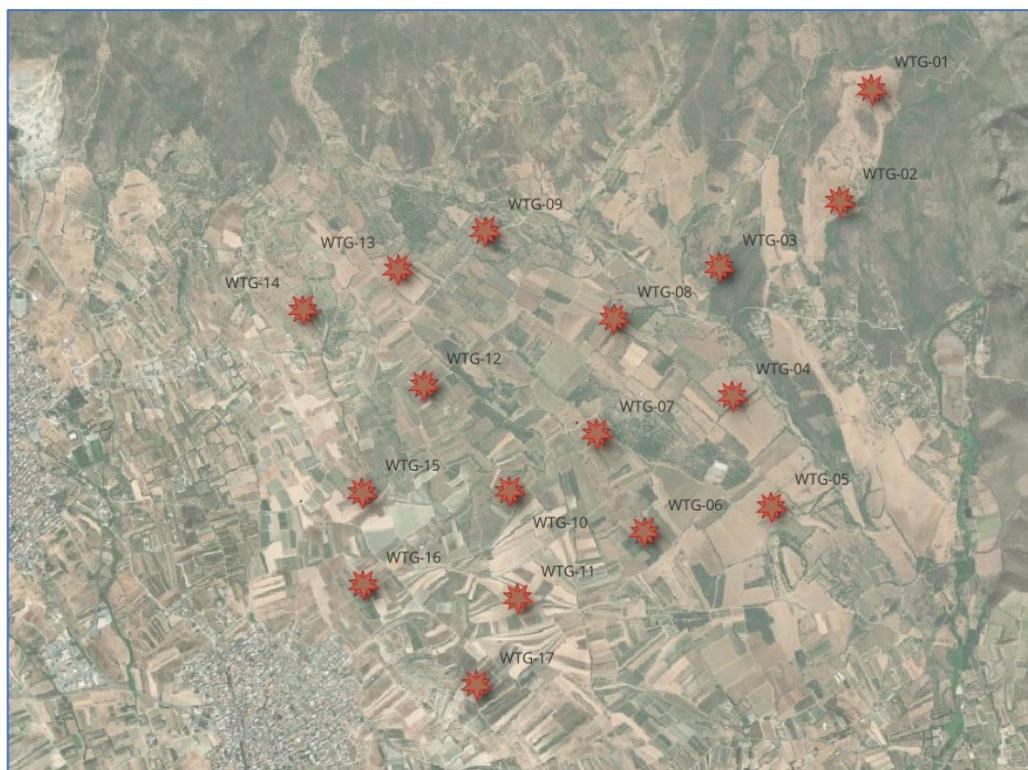
*Figura 39 - Ipotesi Layout a 17 aerogeneratori con collocazione differente*
