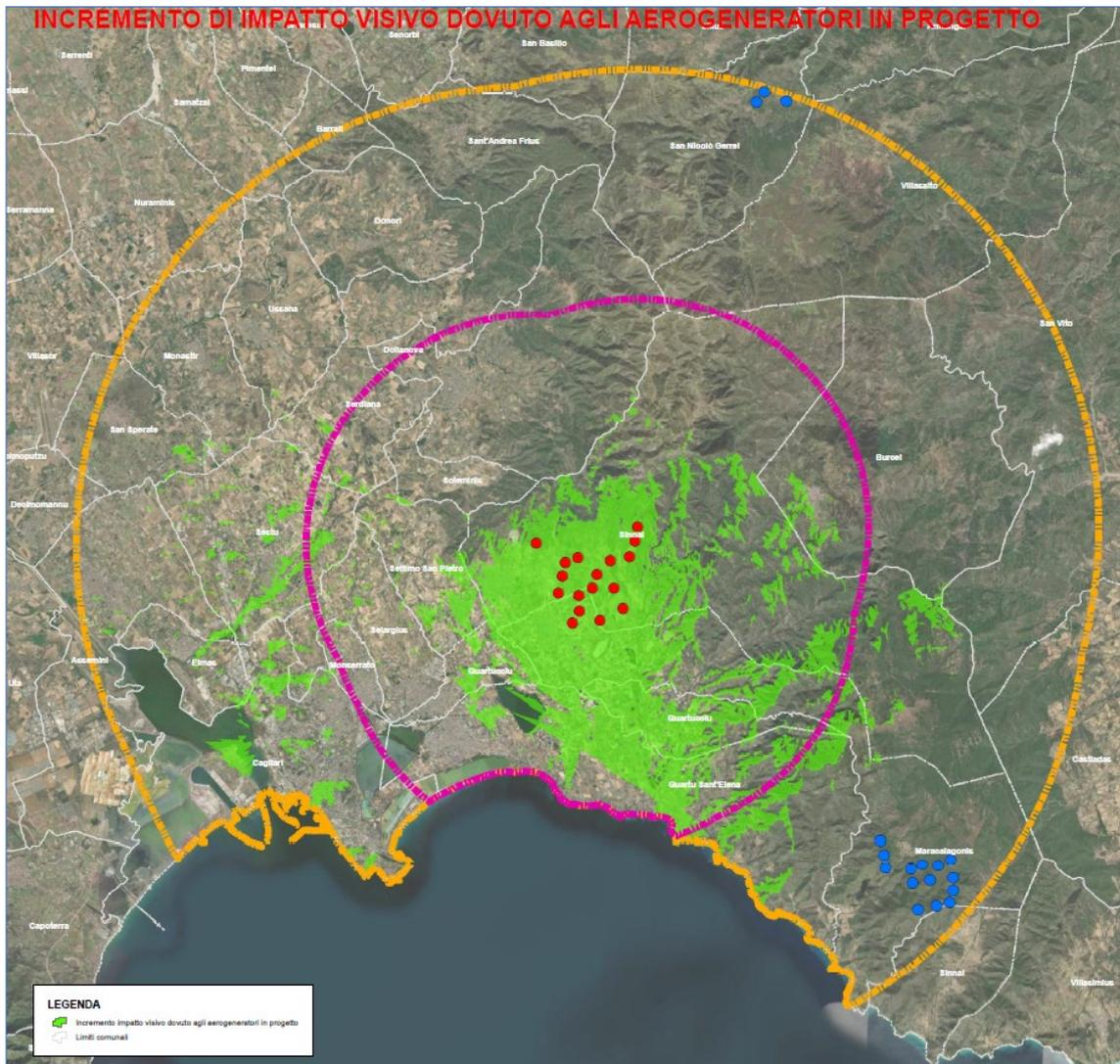
Figura 15 - Mappa della visibilità teorica degli aerogeneratori in progetto
