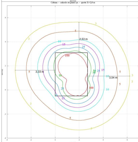
ISOLINEE INDUZIONE MAGNETICA B EMessa DALLA CABINA MT/BT DI SOTTOCAMPO CAMPO. OBIETTIVO DI QUALITÀ DI 3 μT RAGGIUNTO A DISTANZA < DI 3,54 METRI DAL PERIMETRO OCCUPATO DAGLI IMPIANTI. LA DISTANZA DI PRIMA APPROSSIMAZIONE (DPA) SI ASSUME PARI A 4 m.
