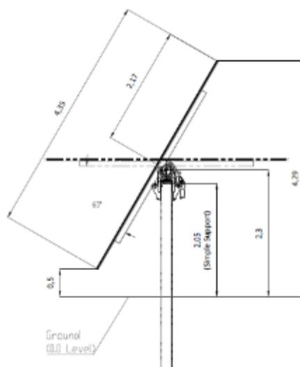
*Figura 2 – Sezione tipo tracker*
