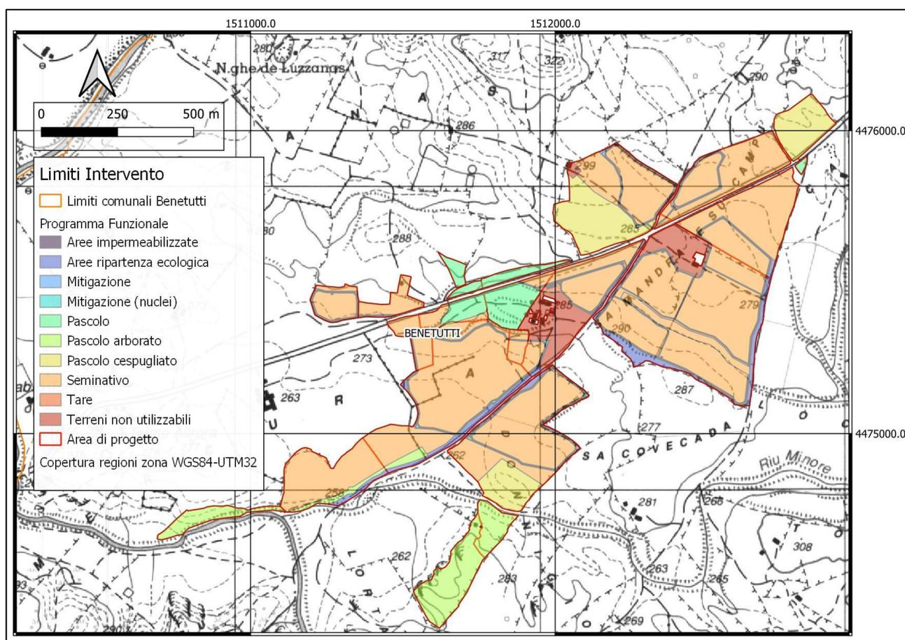
Figura 6.2 - Definizione delle aree nell'ambito del progetto funzionale
