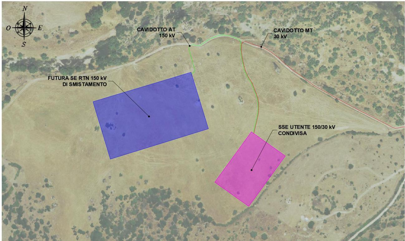
Figura 7.10 – Planimetria opere di connessione Iberdrola Renovables Italia S.p.aimpianto agrivoltaico
