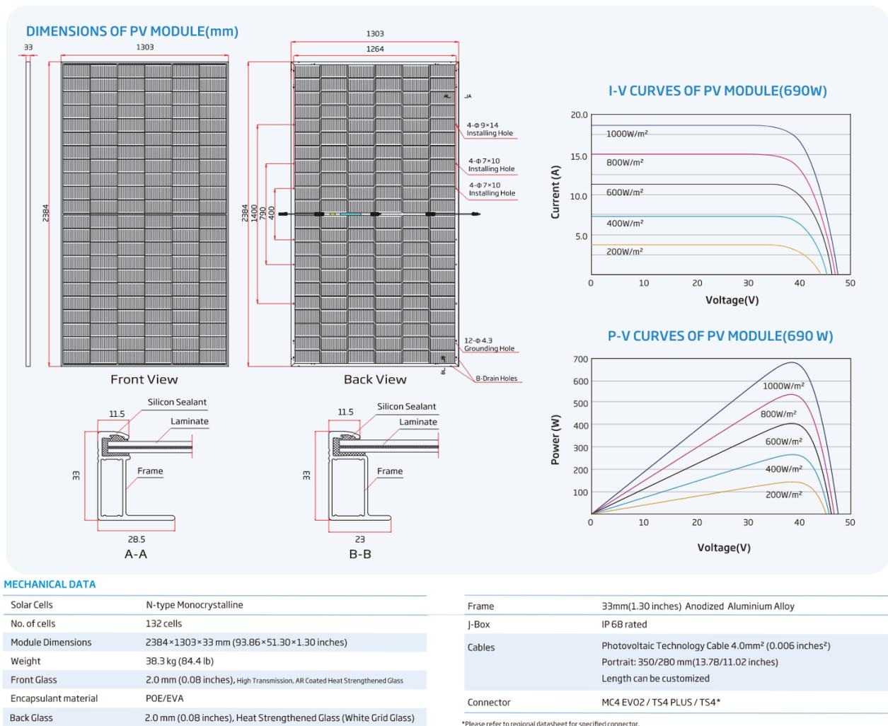
Figura 7.1 – Dati meccanici modulo fotovoltaico Trina Solar – Vertex TSM-NEG21C.20
