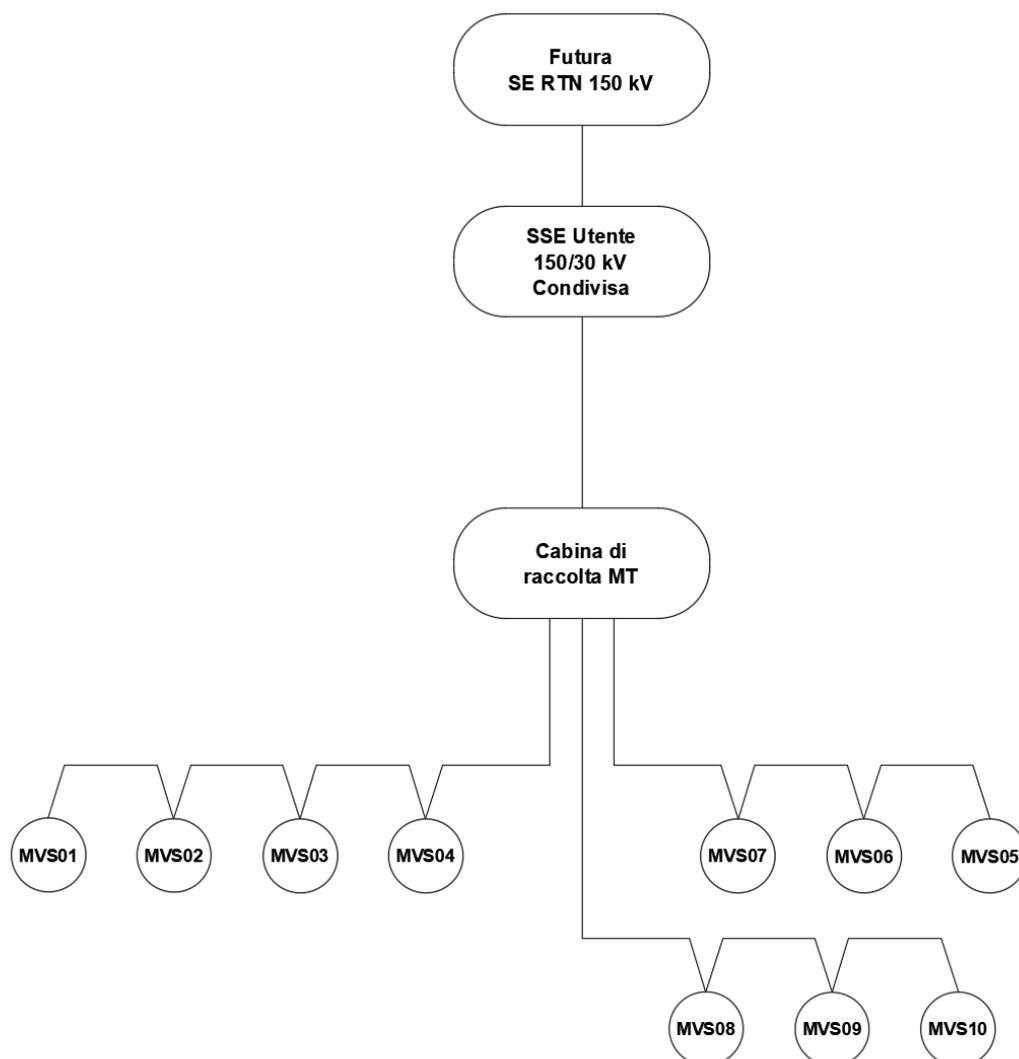
Figura 6.1 - Schema a blocchi impianto FV
