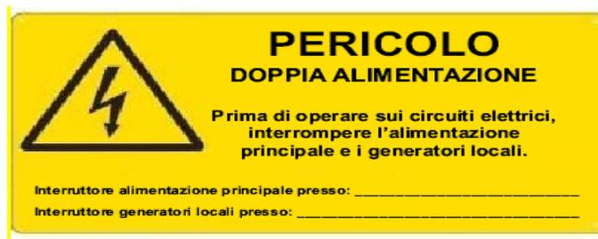
Figura 10.1 - Segnaletica da utilizzare per i lavori sugli impianti FV
