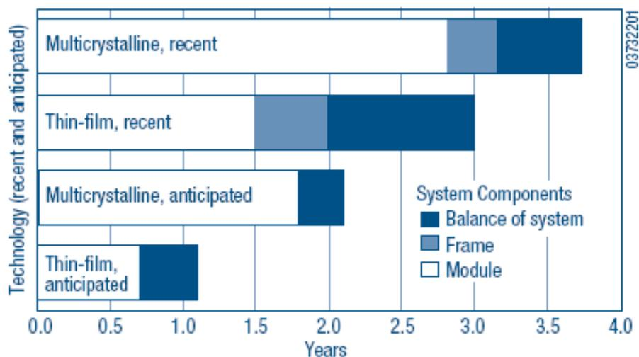
Figura 6.4– Variazione dell’Energy payback per le diverse tecnologie di sistemi fotovoltaici (Fonte, U.S. Dep. Of Energy)
