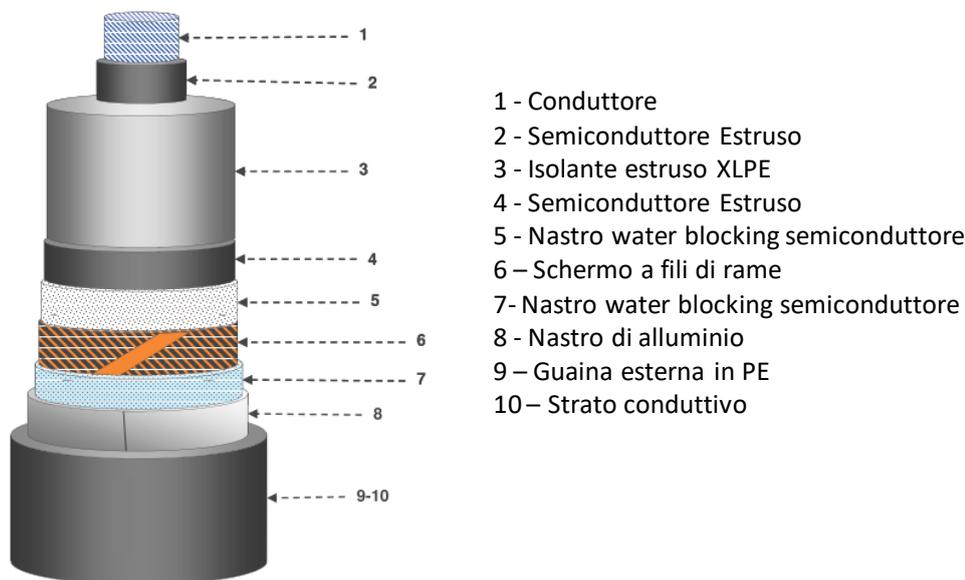
Figura 7.8 - Cavo AT 150 kV tipo ARE4H1H5E 87/150kV
