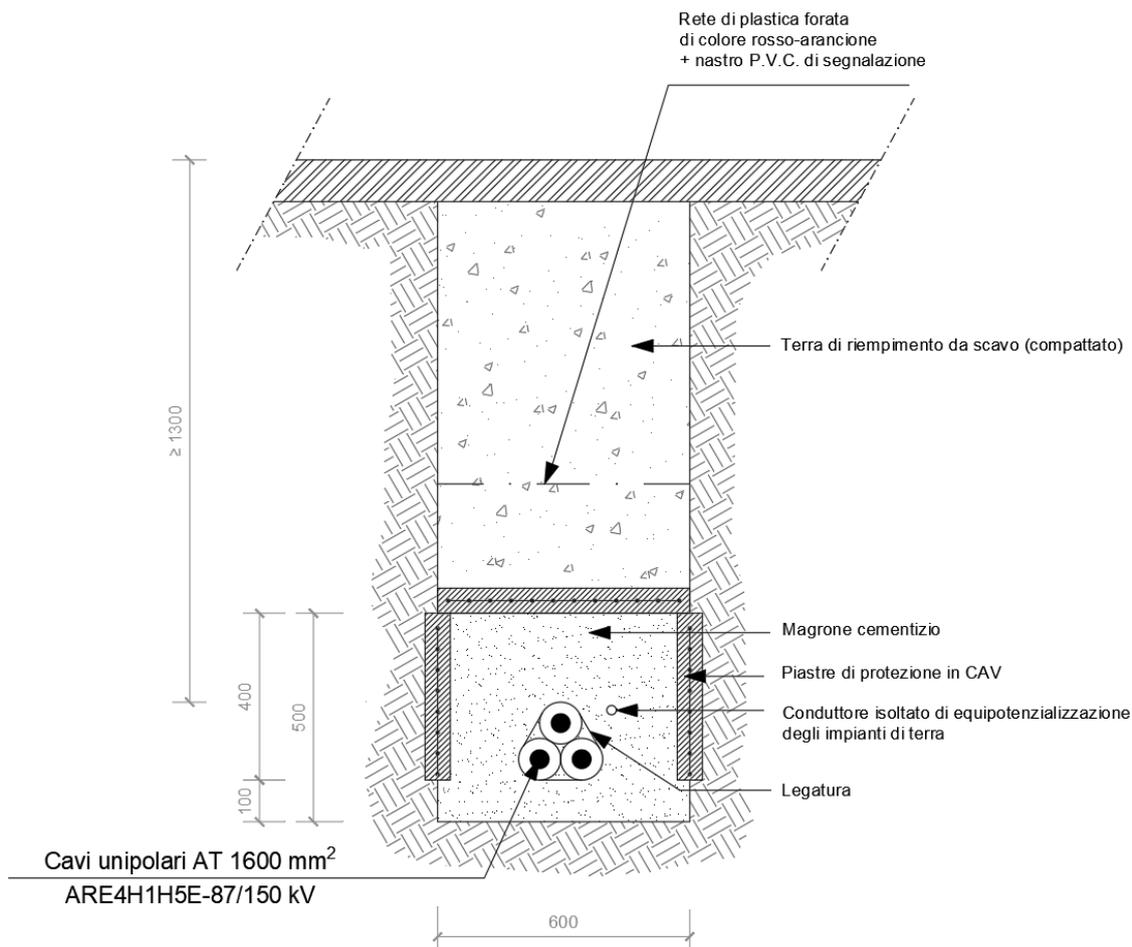
Figura 7.9 - Modalità di posa Cavo AT 150 kV
