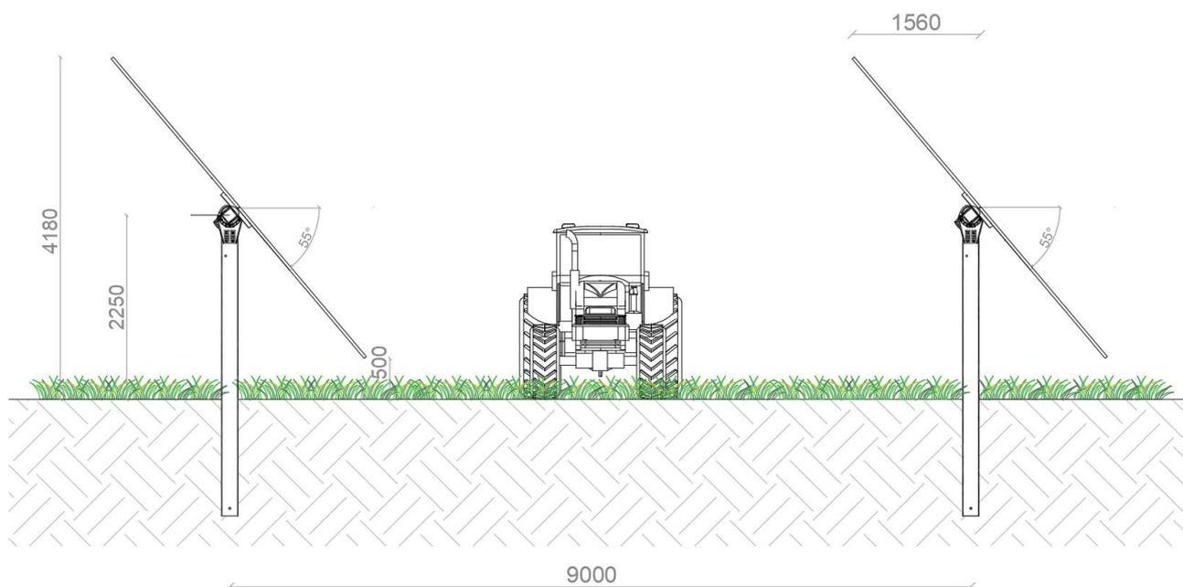
Figura 7.2 - Disposizione degli inseguitori solari
