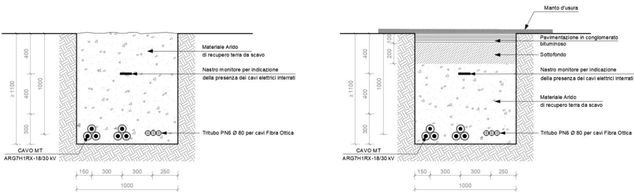
Figura 7.7 - Tipico modalità di posa cavidotto MT di collegamento impianto FV - SSE Utente 150/30 kV
