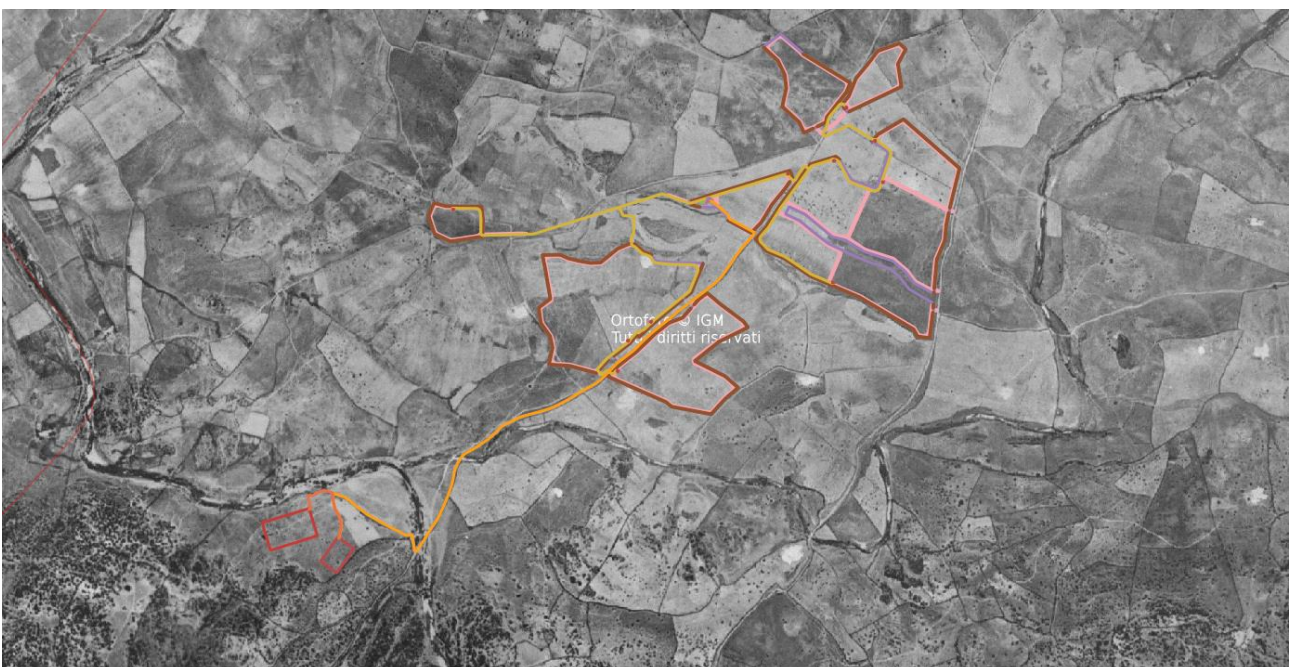
Figura 6. Impianto agrivoltaico (blu), cavidotto MT (giallo), sostazione Utente (blu, di competenza del progetto), cavidotto AT (rosa, di competenza del progetto). La futura stazione RTN Terna (verde) non è di competenza del progetto.
