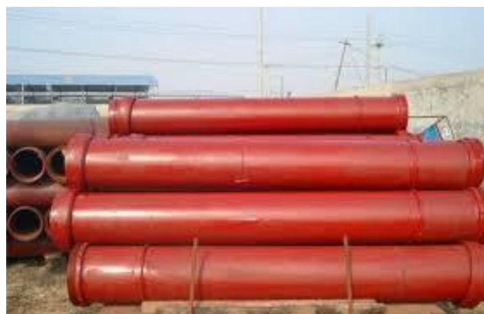
Stoccaggio a terra dei tubi getto
