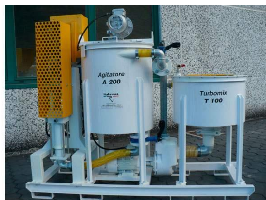
Impianto miscelazione boiacche
