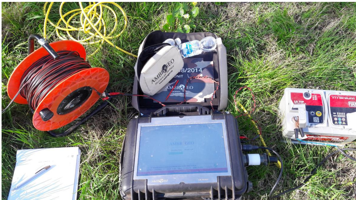
Figura 4: Sismografo digitale a 24 bit.
