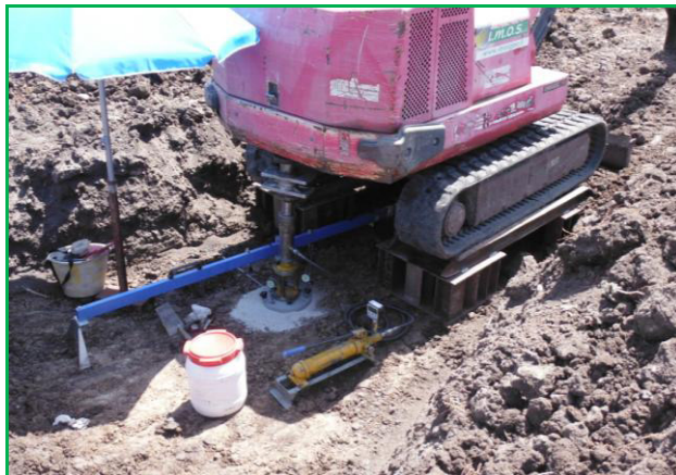
Foto 4.2 – Fase operativa di una prova PLT
