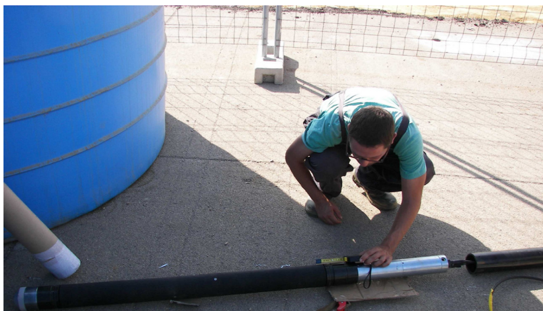
Corpo sonda dilatometro da roccia diam 95 mm
