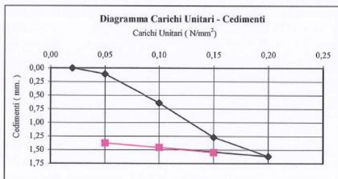
per incrementi di carico tra 0,05 e 0,15 N/mm<sup>2</sup> incremento del cedimento  $\Delta s = 1,16$  mm  $M_d = 25,86$  N/mm<sup>2</sup>
