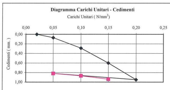
per incrementi di carico tra 0,05 e 0,15 N/mm<sup>2</sup> incremento del cedimento  $\Delta s = 0,53$  mm  $M_d = 56,60$  N/mm<sup>2</sup>
