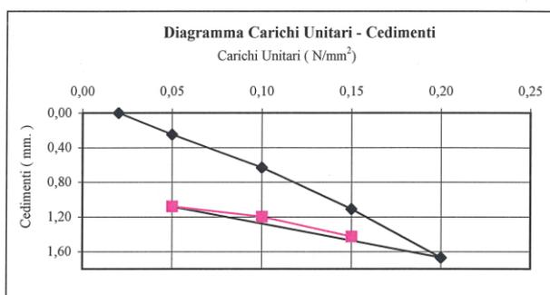
per incrementi di carico tra 0,05 e 0,15 N/mm<sup>2</sup> incremento del cedimento  $\Delta s = 0,86$  mm  $M_d = 34,88$  N/mm<sup>2</sup>
