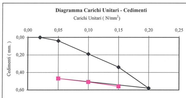
per incrementi di carico tra 0,05 e 0,15 N/mm<sup>2</sup> incremento del cedimento  $\Delta s = 0,30$  mm  $M_d = 100,00$  N/mm<sup>2</sup>
