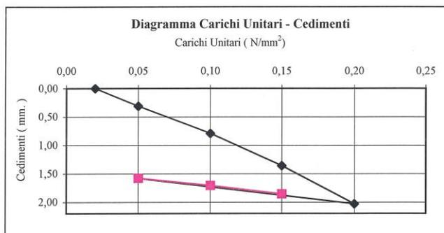
per incrementi di carico tra 0,05 e 0,15 N/mm<sup>2</sup> incremento del cedimento  $\Delta s = 1,05$  mm  $M_d = 28,57$  N/mm<sup>2</sup>
