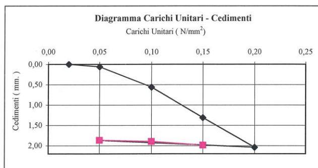
per incrementi di carico tra 0,05 e 0,15 N/mm<sup>2</sup> incremento del cedimento  $\Delta s = 1,25$  mm  $M_d = 24,00$  N/mm<sup>2</sup>
