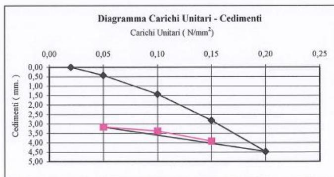
per incrementi di carico tra 0,05 e 0,15 N/mm<sup>2</sup> incremento del cedimento  $\Delta s = 2,39$  mm  $M_d = 12,55$  N/mm<sup>2</sup>
