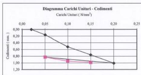
per incrementi di carico tra 0,05 e 0,15 N/mm<sup>2</sup> incremento del cedimento  $\Delta s = 0,60$  mm  $M_d = 50,00$  N/mm<sup>2</sup>
