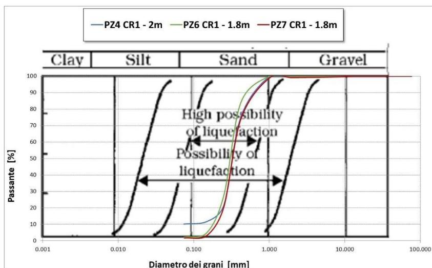
**Figura 18 Fusi granulometrici di terreni suscettibili alla liquefazione per  $U_c < 3.5$**
