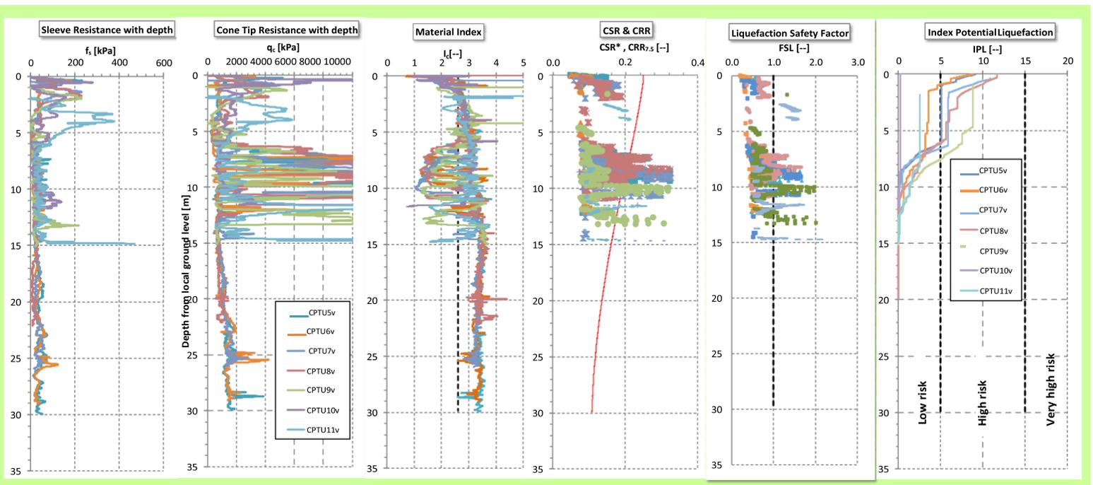
**Figura 10** Sintesi delle analisi di liquefazione da prove CPT (CPT15V, CPT16V, CPT17V, CPT18V, CPT19V, CPT10V, CPT11V) – indagini in categoria D
