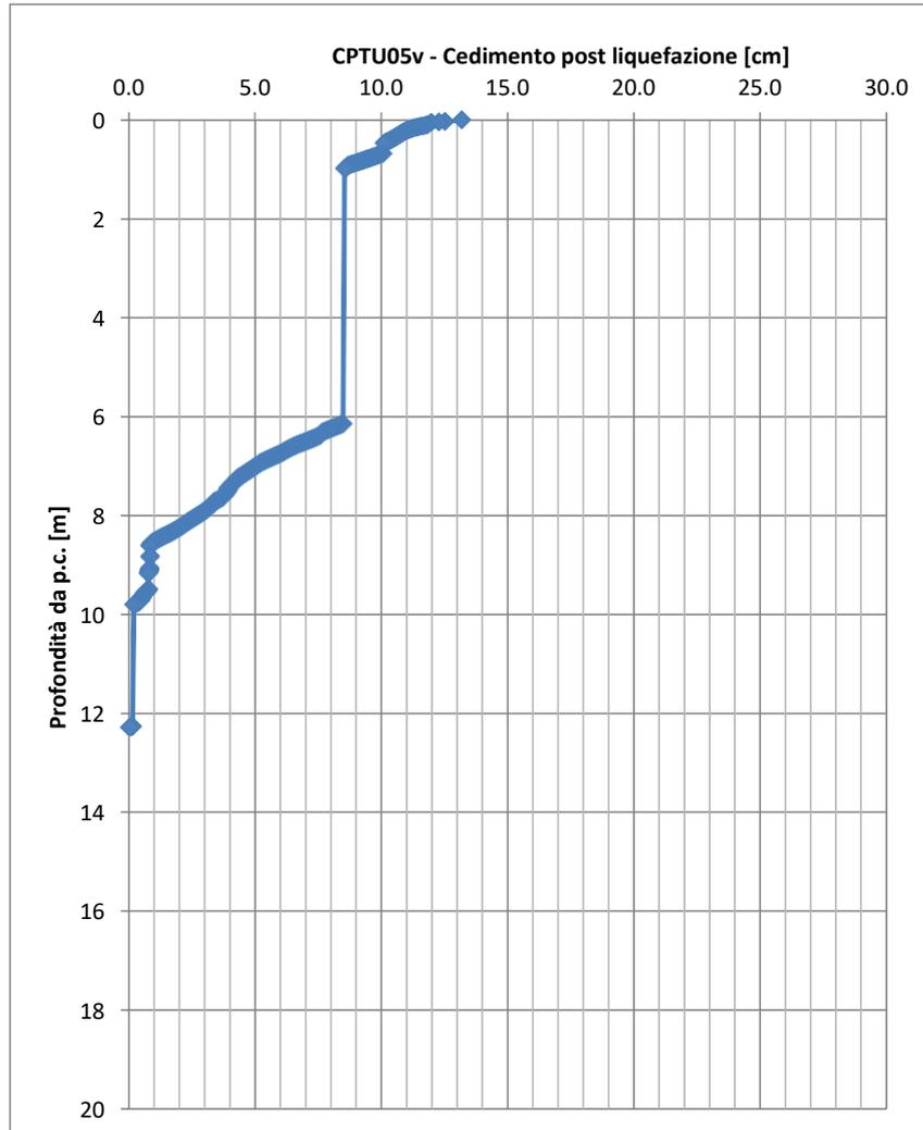
**Figura 23 – Cedimento stimato post-liquefazione - CPTU5v (cedimento post-sismico = 13.2 cm)**
