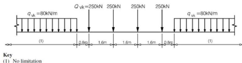
**Figura 27 Load model 71 (al punto 6.3.2. della norma EN 1991-2:2003)**
