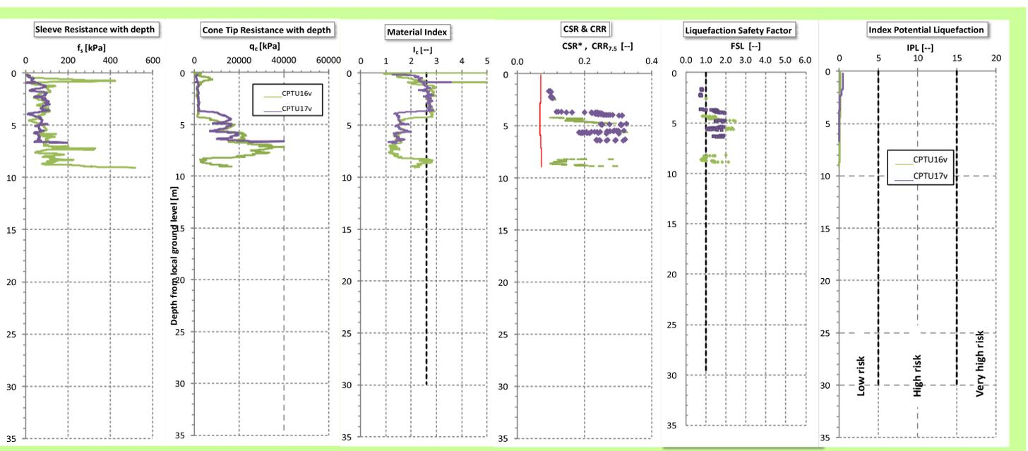
**Figura 15 Sintesi delle analisi di liquefazione da prove CPT (CPTU16V, CPTU17V)**
