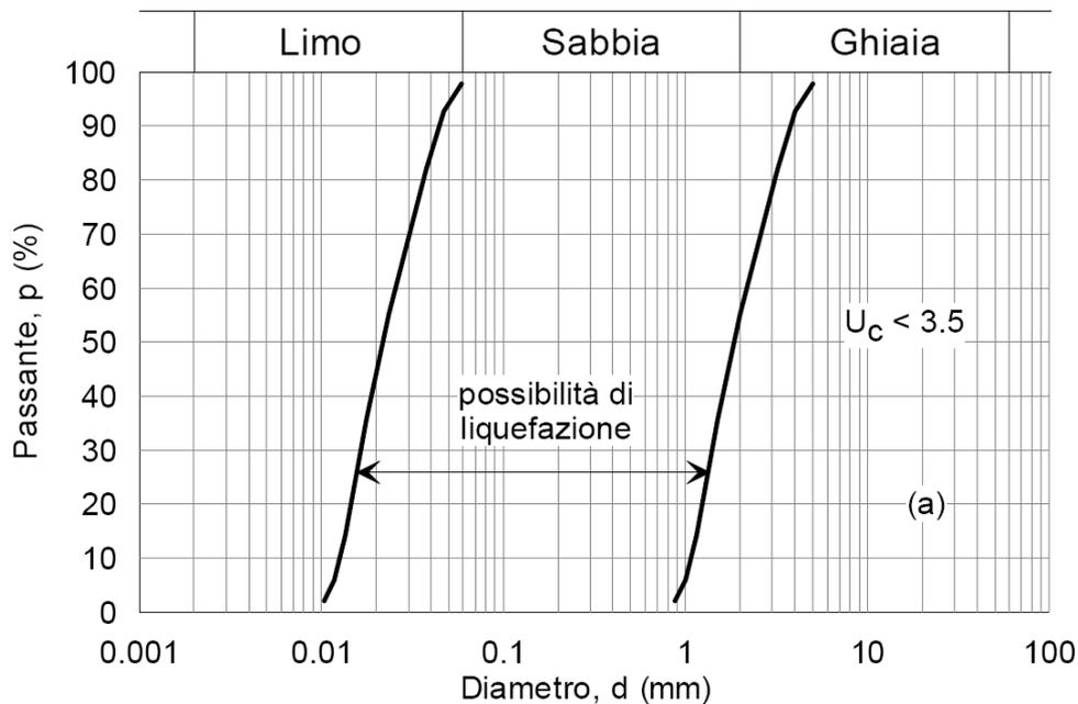
**Figura 5 - Fusi granulometrici di terreni suscettibili alla liquefazione per  $U_c < 3.5$**
