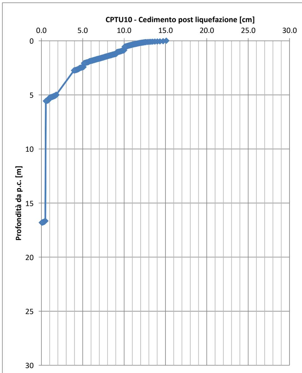
Figura 26 – Cedimento stimato post-liquefazione - CPTU10 (cedimento post-sismico = 15.1 cm)
