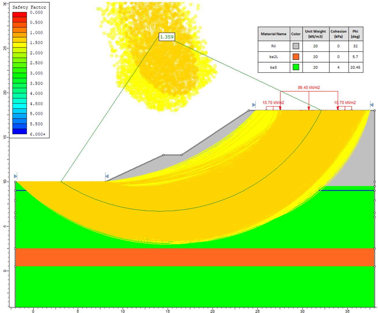
Figura 28 – Verifica di stabilità rilevato ferroviario RI23 – post liquefazione
