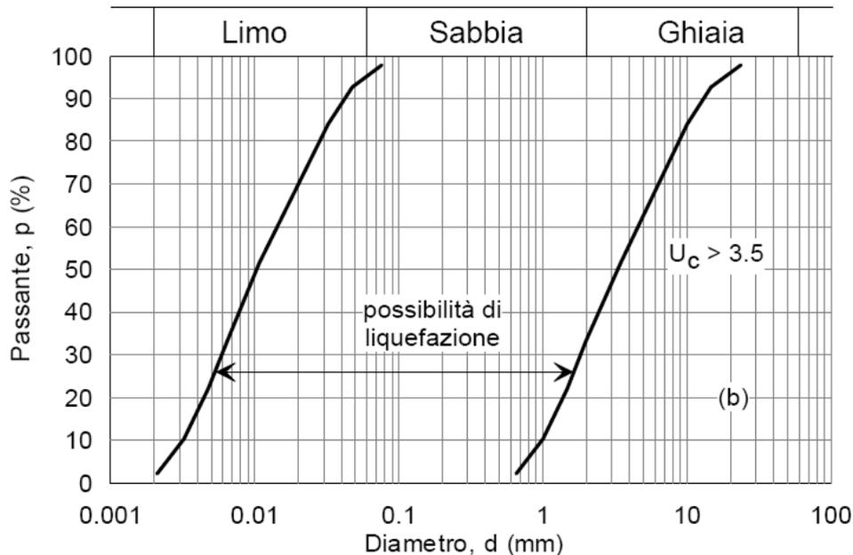
**Figura 6 - Fusi granulometrici di terreni suscettibili alla liquefazione per  $U_c > 3.5$**
