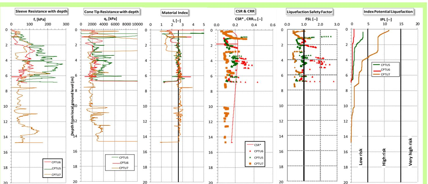
Figura 17 Sintesi delle analisi di liquefazione da prove CPT (CPTU5, CPTU6, CPTU7)
