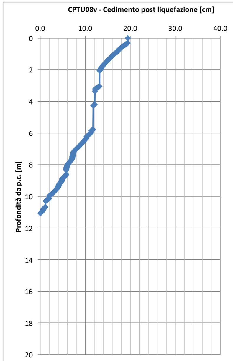
Figura 24 – Cedimento stimato post-liquefazione - CPTU8v (cedimento post-sismico = 19.5 cm)
