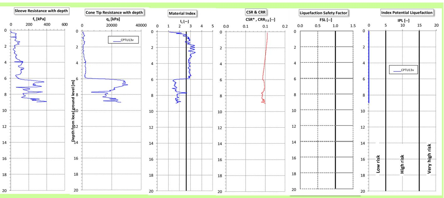
**Figura 13 Sintesi delle analisi di liquefazione da prove CPT (CPT13V)**
