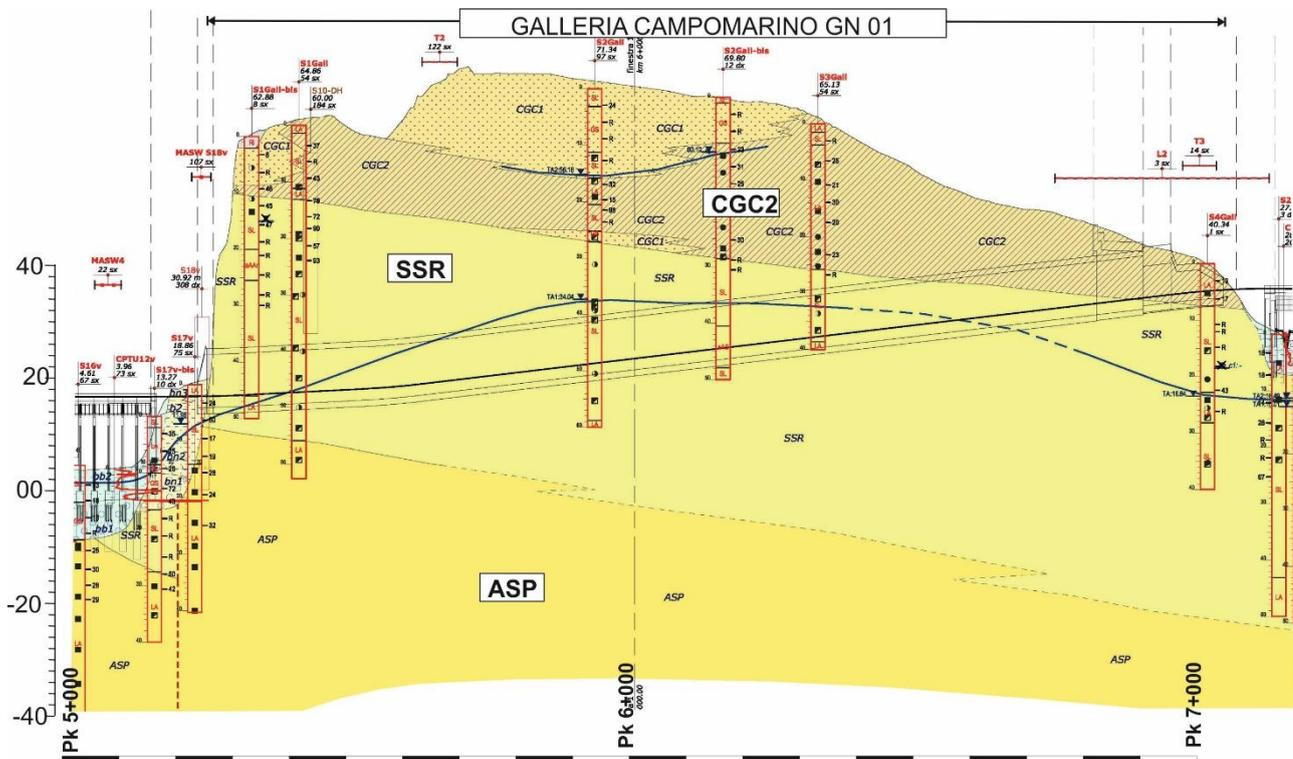
**Figura 0-1 profilo geologico-geotecnico di progetto galleria**
