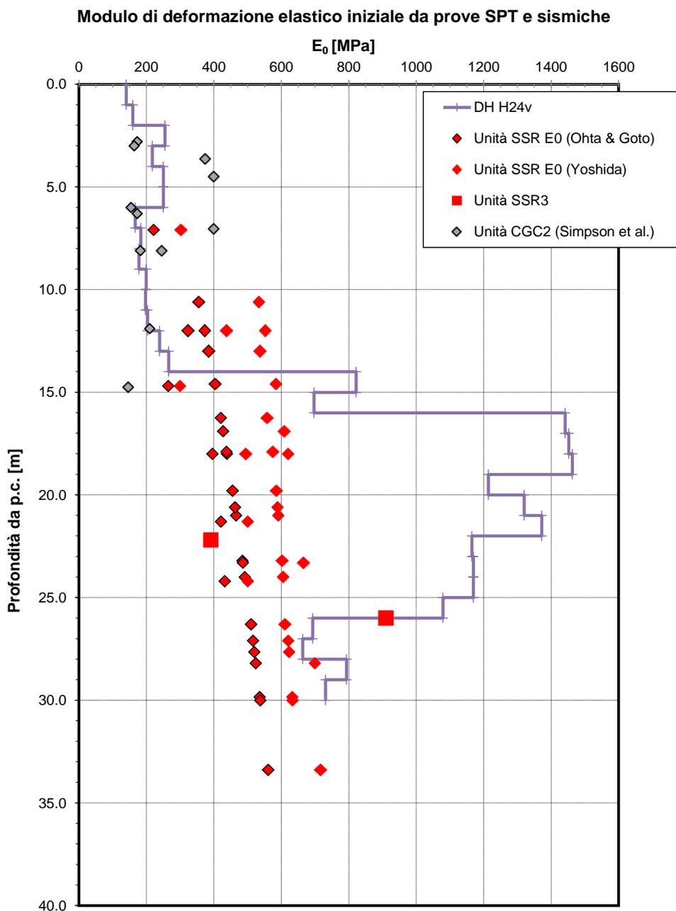
**Figura 21 – Modulo di deformazione elastico iniziale da prove SPT – Unità CGC2, SSR, SSR3**
