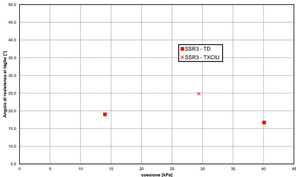
**Figura 31 – Andamento della coesione e dell'angolo di resistenza al taglio – Unità SSR3**
