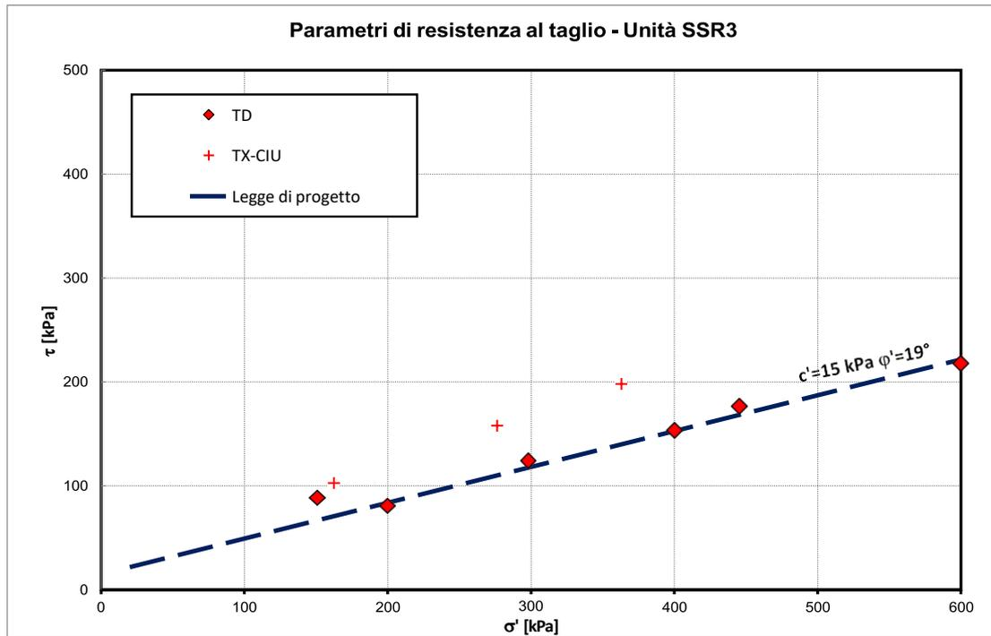
**Figura 32 – Parametri di resistenza al taglio – Unità SSR3**
