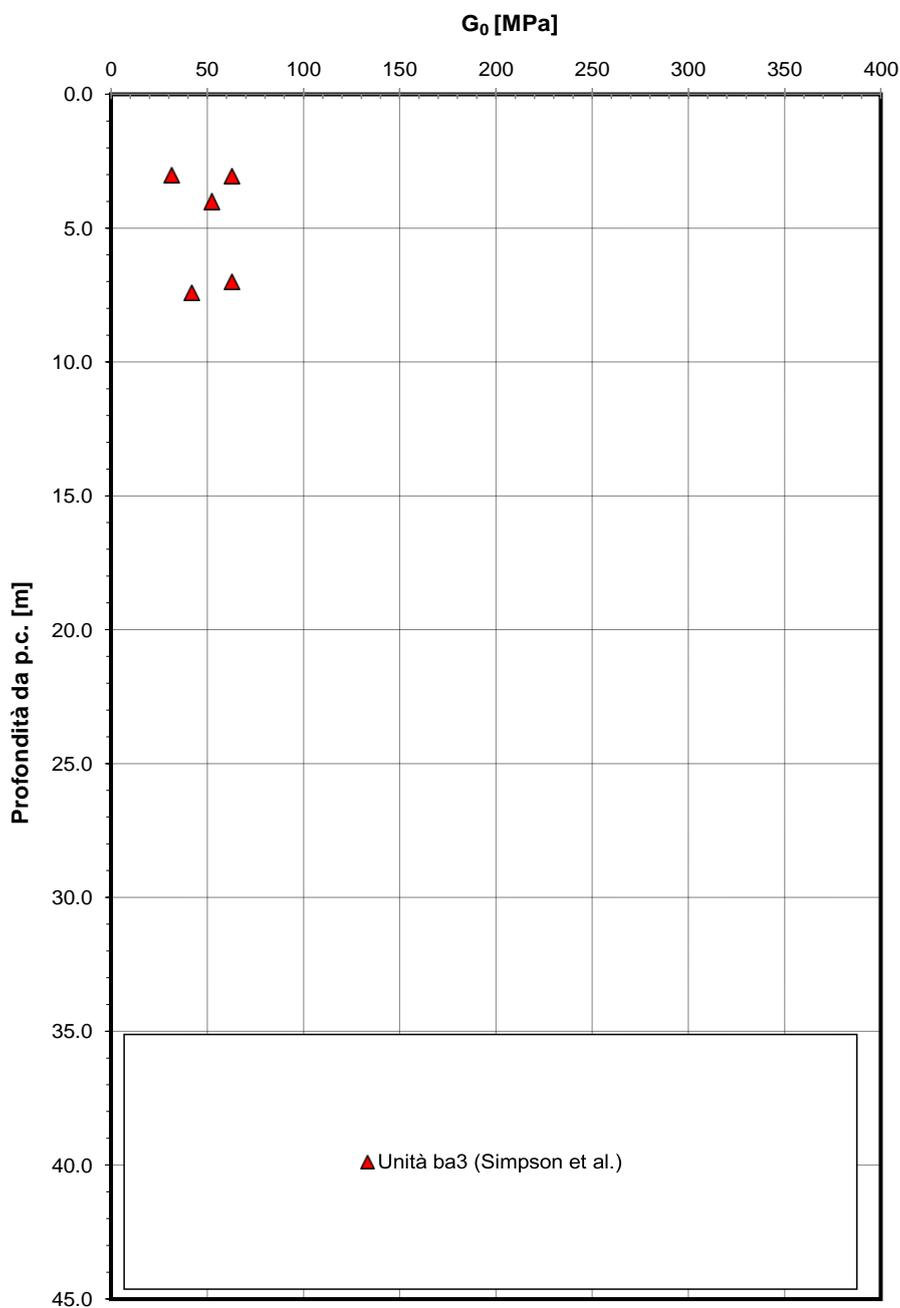
**Figura 10 – Modulo di deformazione a taglio iniziale da prove SPT e sismiche – Unità ba3**
