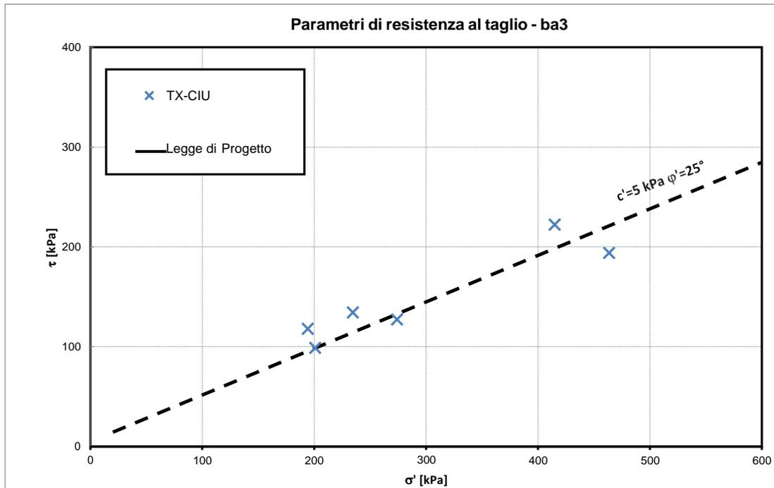
**Figura 8 – Parametri di resistenza al taglio – Unità ba3**
