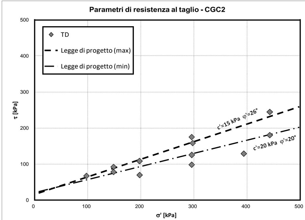
**Figura 17 – Parametri di resistenza al taglio – Unità CGC2**
