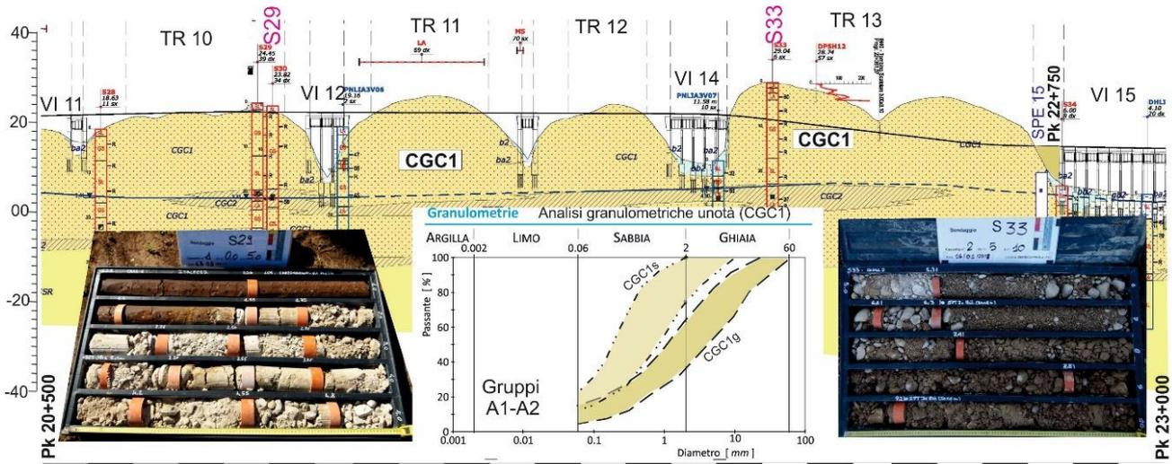
Pertanto, anche questi materiali di scavo, così come per l'unità SSR della galleria, possono essere utilizzati come materiale tal quale nella realizzazione delle opere in rilevato.
