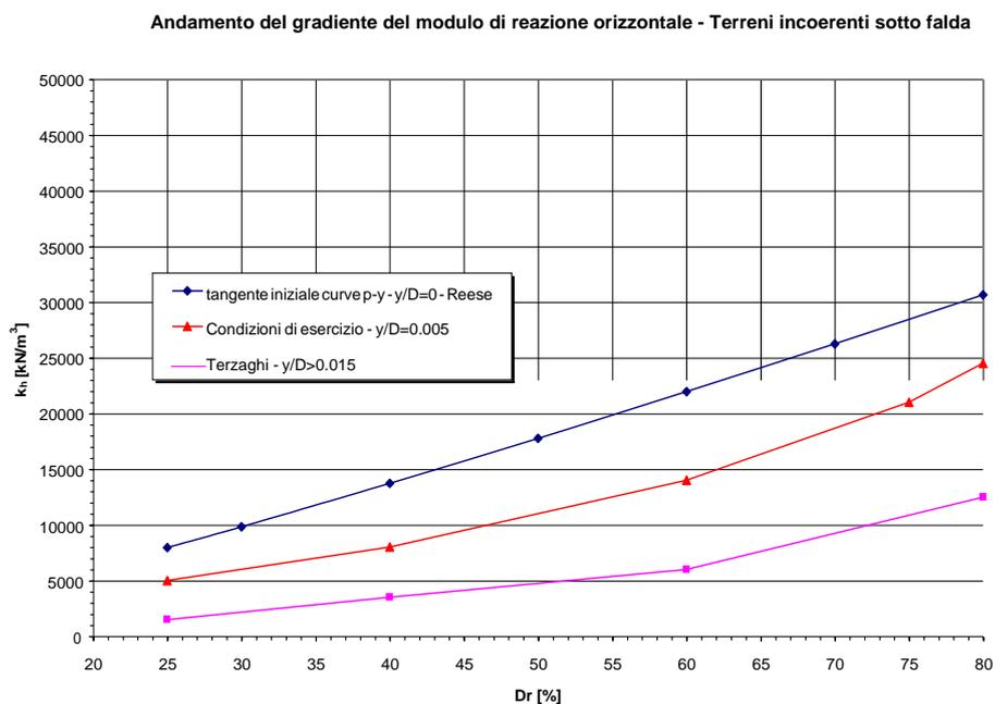
**Figura 35. Andamento del gradiente del modulo di reazione orizzontale – Terreni sotto falda**
