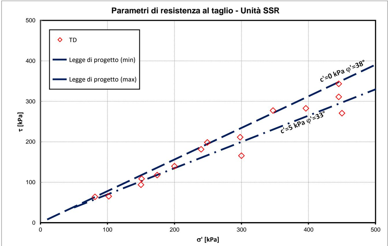
**Figura 29 – Parametri di resistenza al taglio – Unità SSR**
