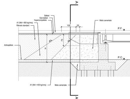
SEZIONE SCHEMATICA DEL CORPO STRADALE
