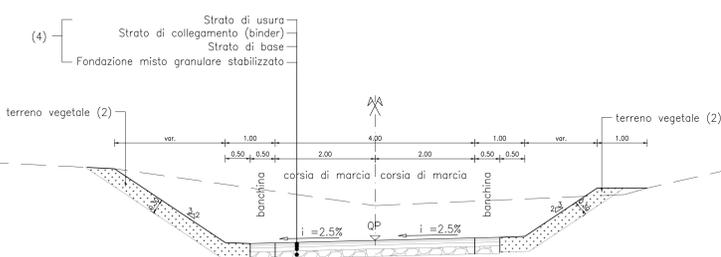
SEZIONE TIPO A DESTINAZIONE PARTICOLARE IN TRINCEA (NV02A-NV02B)
