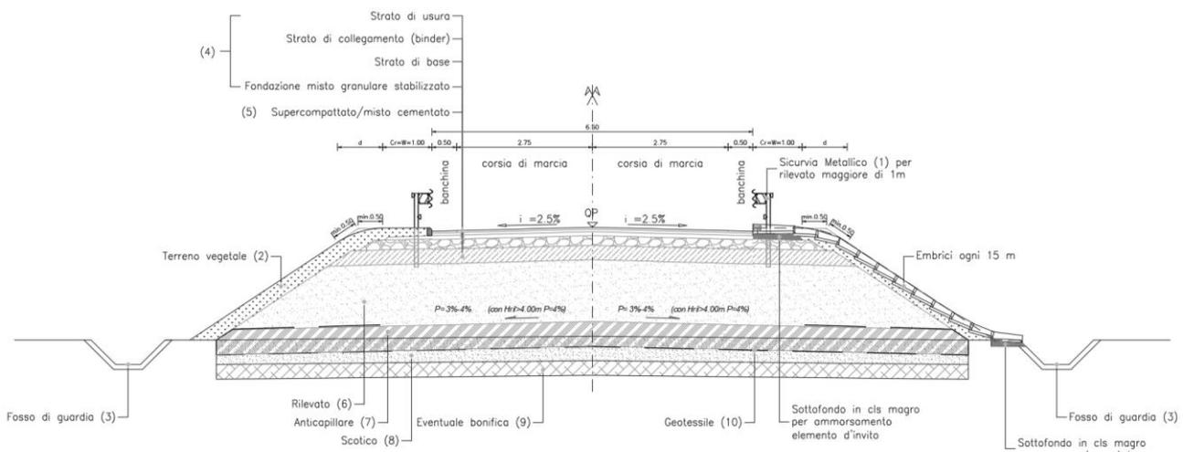
Figura 8 - Sezione tipo in rilevato
