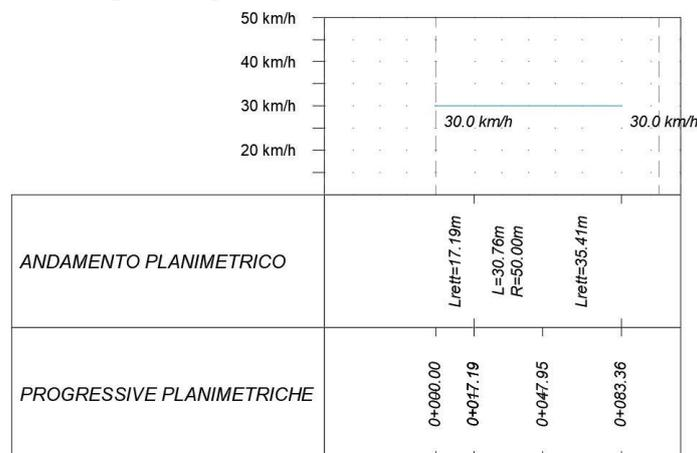
Sulla base del diagramma di velocità sono stati verificati gli elementi planimetrici ed altimetrici e le condizioni di visibilità.
