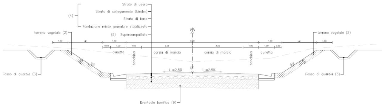
**Figura 3 - Sezione tipo in trincea**
