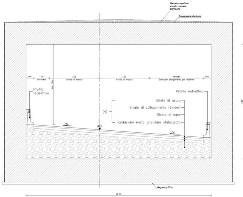
**Figura 4 - Sezione tipo in sottovia**
