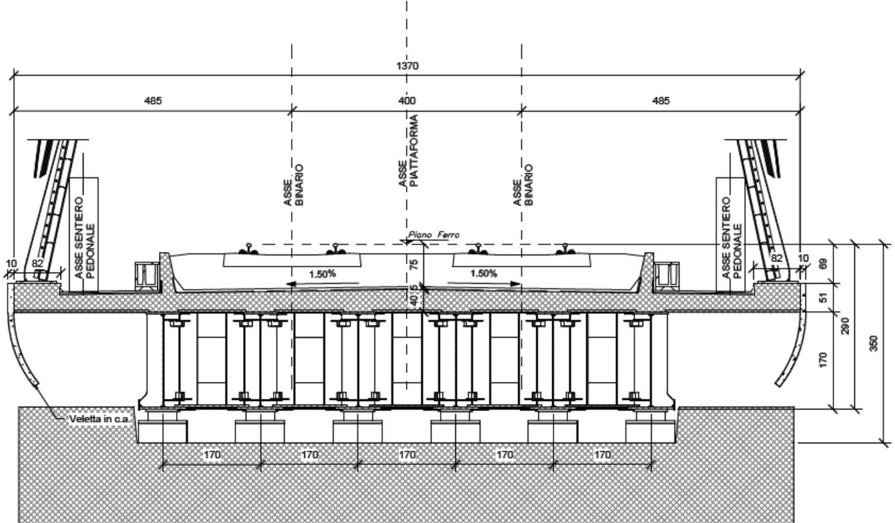
Figura 2 – Sezione trasversale impalcato
