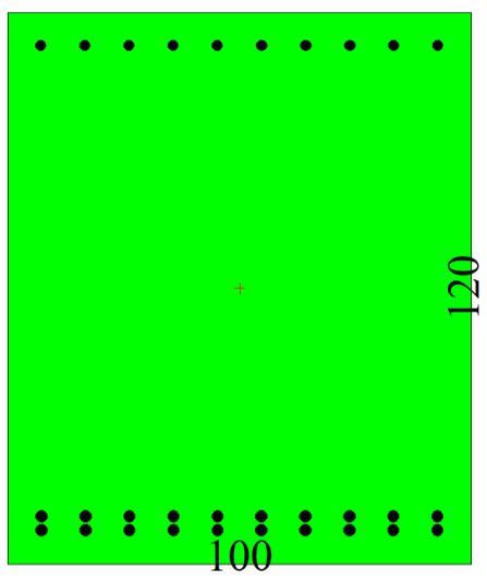
Figura 40 – Sezione trasversale muro d'ala e relativa armatura
