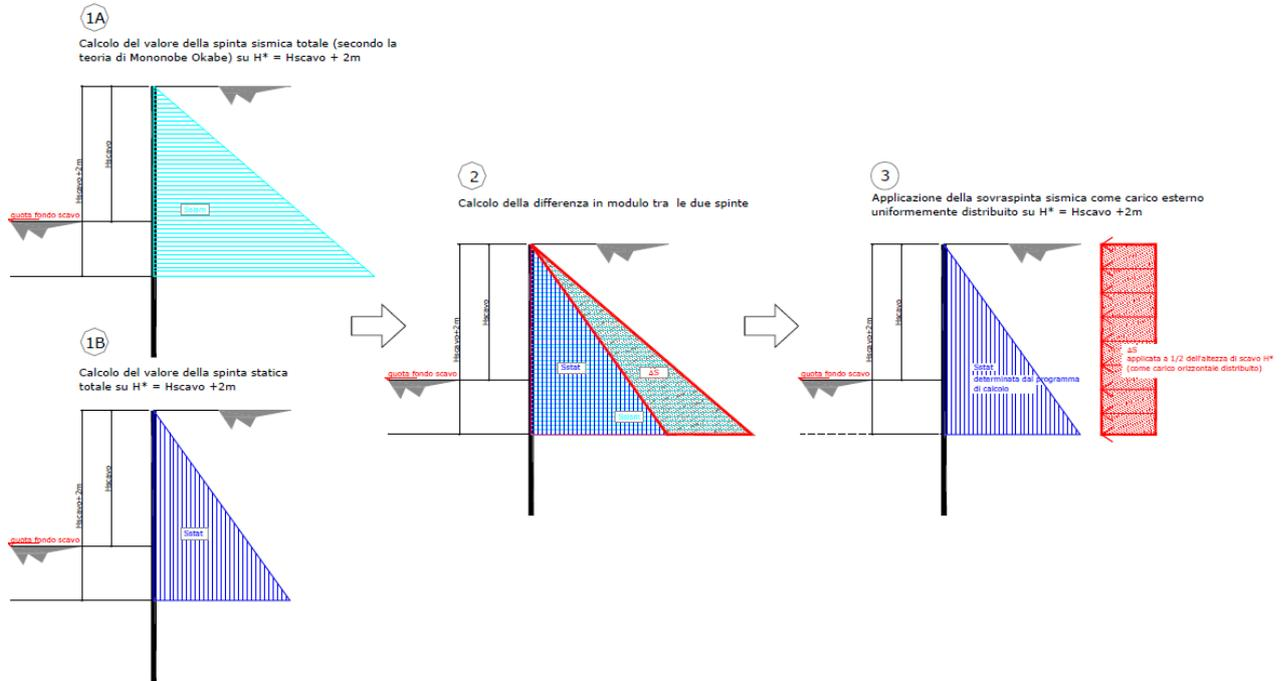
Figura 25 - Schema di calcolo sovrappinte dinamiche terreno
