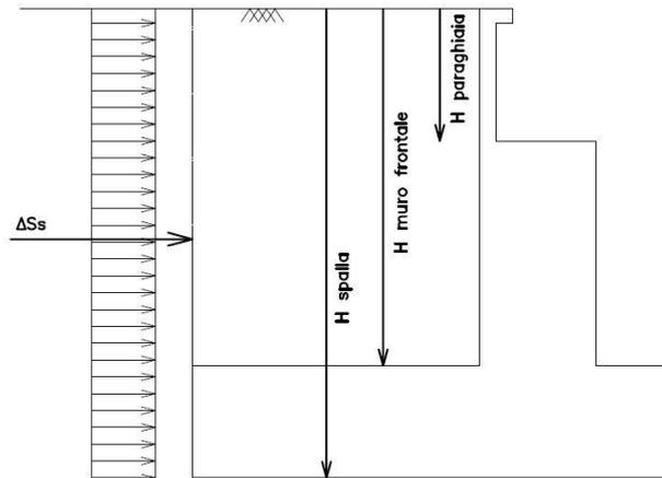
Figura 26: Schema per il calcolo degli effetti della sovrappinta sismica
