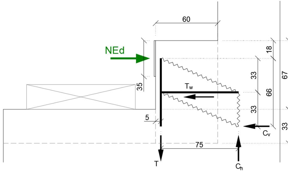
*Figura 45 – Schema delle verifiche locali del ritegno longitudinale*
