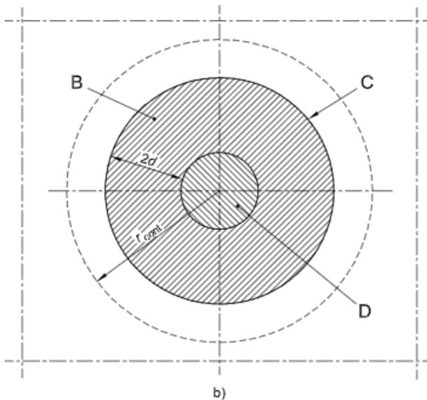
figura 6.12 Modello di verifica a punzonamento allo stato limite ultimo
